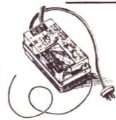
Récepteur à super-réaction: 27 MHz. Fonctionne sur réception d'une onde pure ou modulée en 27 MHz. Alimentation par pile 9 volts. Poids: 90 g. En coffret plastique de
