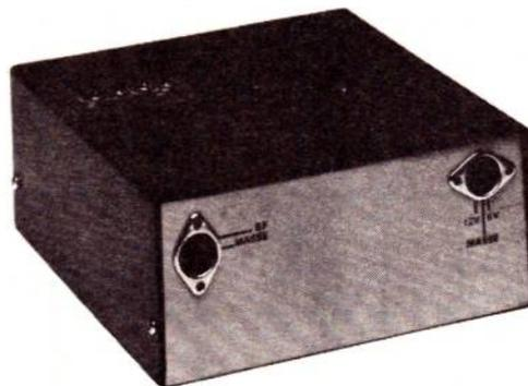
▲ Vue arrière de la batterie. La prise de raccordement alimentation est visible à droite.
