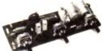
**CX6** - Amplificateur 5 W musique. Entrée 200 mV. Cellule piézo. Sortie 4-8 Ω. Alimentation 12-18 V. Double correction de tonalité. Fusible de protection. Redresseur et filtrage inclus.
