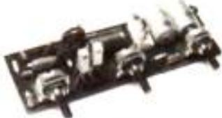
**CX6** - Amplificateur 5 W musique Entrée 200 mV. Cellule pézo. Sortie 4-8 Ω. Alimentation 12-18 V. Double correction de tonalité. Fusible de protection. Redresseurs et filtrage inclus.
