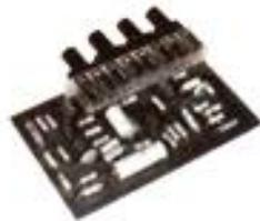
**CX 12**. Préampli correcteur stéréo, avec commutateur M/A, P.U., tuner, magnéto. Convient en particulier pour 2 CX 7. En ordre de marche ..... 85,00 F
