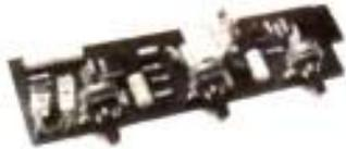
**CX7** - Amplificateur 7 W Musique. Entrée 200 mV. Cellule pézo. Sortie 4-8 Ω. Alimentation 12-18 V. Double correction de tonalité. Montage Baxandall. Fusible de protection. Redresseurs et filtrage inclus.
