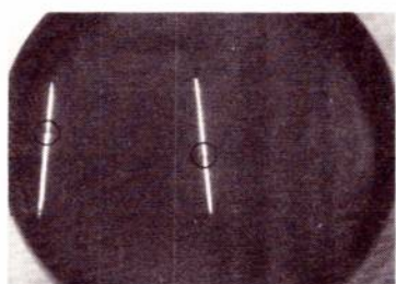
14 - Distorsion de raccordement visible sur l'écran ( F = 1\ 000 Hz).
