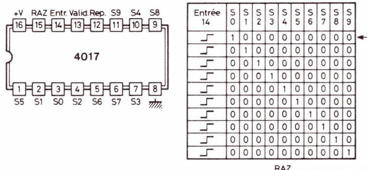
Figure 8 : brochage et tableau de fonctionnement du 4017.
