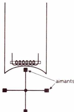
Figure 2 : principe du capteur de vitesse.
