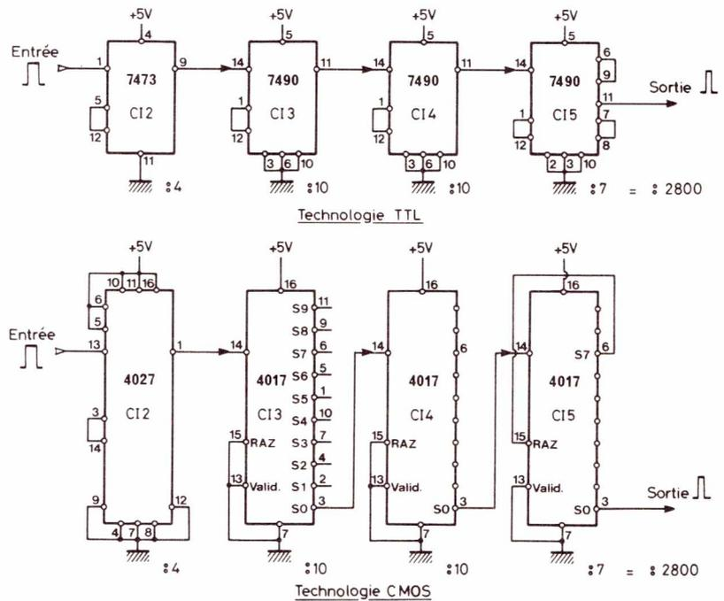
Figure 7 : schéma de principe de la division
