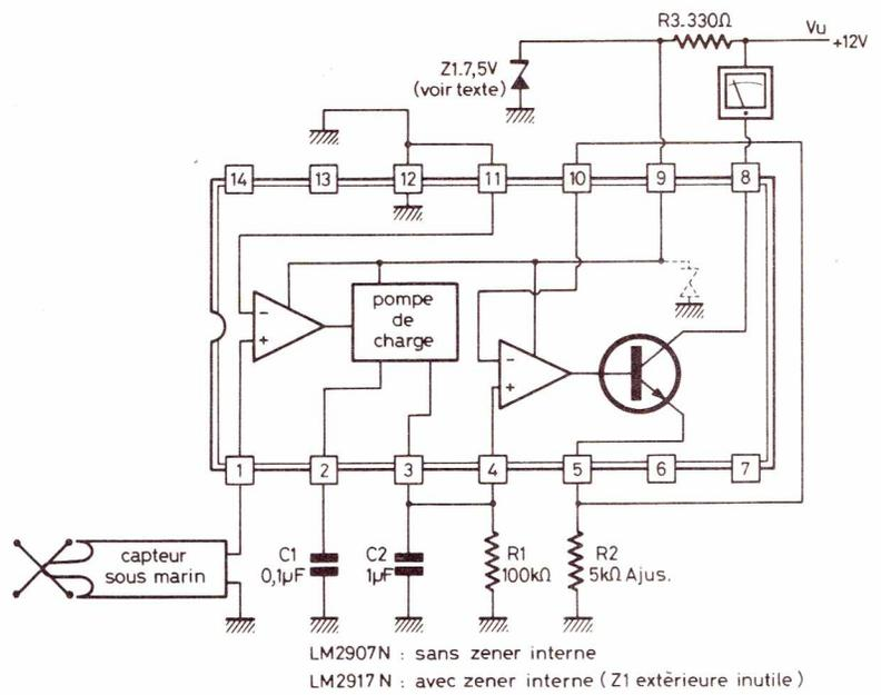
Figure 3 : schéma pratique du speedomètre utilisant le CI LM 2907 ou 2917 version 8 broches.
