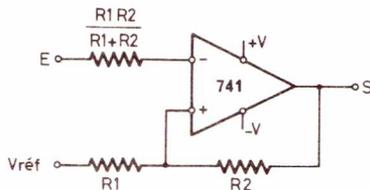
$$\text{seuil H} = V_{\text{réf}} - \frac{R1}{R1+R2} (V_{\text{réf}} - V_S \text{ max})$$
