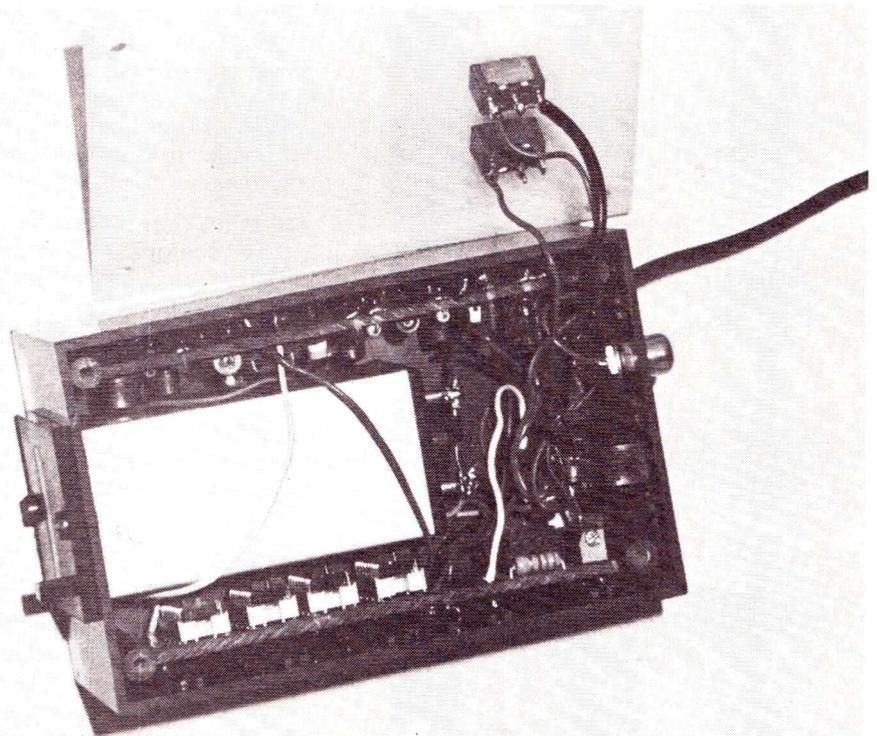
*L'ensemble monté — le compteur est sur le dessus, les différentes prises en dessous — les deux interrupteurs sont fixés sur le couvercle : les différentes liaisons se font en fils souples.*
