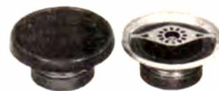
**D-730** - H.P. hi-fi à 2 voies (boomer Ø 16 cm, tweeter 5 cm), flux magnétique 15.000 gauss, réponse 60 à 16.000 Hz, puissance admissible **30 WATTS**, impédance 4 ohms, profondeur d'encastrement 55 mm, grille décor amovible.
