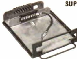
L'autoradio est monté sur un tiroir coulissant qui s'insère dans un support fixé à demeure dans ou sous le tableau de bord. Les raccordements H.P., antenne et alimentation sont reliés à un connecteur mâle sur le tiroir, qui s'enclenche dans son équivalent femelle sur le support. Une poignée sur le tiroir permet le retrait de l'autoradio, pour le soustraire à toute - convoitise - et sert également d'anse de portage. L. 195, H. 65, P. 215 mm.
