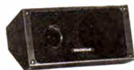
Composé d'une platine - design - dim. 225 x 115 mm, supportant les H.P., et fixée sur boîtier inférieur en forme de pupitre (hauteur tot. 117 mm). Equipement : 1 woofer 102 mm, 1 tweeter à dôme, 1 filtre de séparation, réponse en fréq. 50 à 22.000 Hz, puissance max. admissible **60 WATTS**, impéd. 4 ohms, présentation de haut standing.
