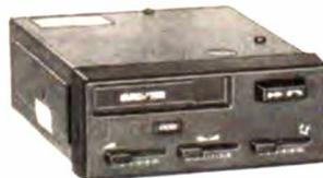
Lecteur stéréo pouvant recevoir tous types de cassettes (support magnét. Fe ou Cr), défil. 4.75 cm/s, pleurage < 0.3 %, puissance totale 10 WATTS (2 x 5 W), contrôle de volume, tonalité, balance stéréo, touche combinée AVANCE rapide et EJECTION cassette, auto-stop fin de bande, sorties H.P. impéd. 4 ohms, alim. 12 Volts (— à la masse), L. 120, H. 48, P. 150 mm.
