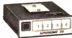
Comme pour ouvrir un coffre fort, il y a lieu avec cet anti-vol auto de connaître la combinaison pour que 1°) le moteur puisse démarrer, 2°) pour désarmer l'alarme qui engendrerait dans les 15 secondes l'ouverture des portes ou capots, 3°) pour neutraliser l'alarme qui engendrerait également le - sensor - (3 sensibilités), suite à un choc malveillant, effraction, prélevement d'organe.
