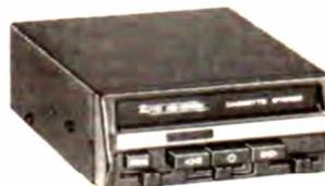
Permet d'auditionner automatiquement et en chaîne les 2 enregistrements d'une cassette, sans avoir à éjecter ni retourner la cassette, sélecteur de pistes (1-3 ou 2-4), touches d'AVANCE et RETOUR rapide de la bande, éjection cassette, contrôle de volume, tonalité, balance stéréo, puissance totale 16 WATTS (2 x 8 W), sorties H.P. impéd. 4 à 8 ohms, alim. 12 volts (- à la masse), larg. 120, haut. 48, prof. 150 mm. Livré avec accessoires de montage
