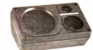
Composé d'une platine - design - dim. 142 x 235 mm, supportant les H.P., et fixée sur boîtier inférieur en forme de pupitre (hauteur avant/arrière 64/110 mm). La platine peut s'installer au besoin sans boîtier, en formule H.P. encastrés. Equipement : 1 woofer 120 mm, 1 médium 75 mm, 1 tweeter 4 cm, - filtres de fréquences impéd. 4 ohms, puissance max. admissible 25 WATTS, réponse en fréq. 80 à 16.000 Hz.
