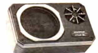
Composé d'une platine - design - dim. 150 x 240 mm, supportant les H.P., fixée sur boîtier inférieur en forme de pupitre (hauteur avant/arrière : 55/110 mm). Equipement : 1 woofer Ø 138 mm - 1 tweeter Ø 66 mm, impédance 4 ohms, puissance admissible 30 WATTS music., réponse en fréquence 70 à 18.000 Hz - La platine peut s'installer sans boîtier, en formule H.P. encastrés. Présentation gris sombre métallisé, décor alu brossé.
