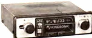
Recepteur **GO - PO - FM** mono et stéréo (MPX) avec C.A.F., voyant d'émissions stéréo - Lecteur toutes cassettes stéréo (bandes Fe ou Cr), touche combinée **AVANCE** rapide de la bande et **EJECTION** cassette, auto-stop fin de bande, commandes de volume, tonalité, balance stéréo, puissance tot. **12 WATTS** (2 x 6 W), impéd. H.P. 4 à 8 ohms, alim. 12 V (- à la masse), L. 180, H. 48, P. 160 mm - Livré avec 2 H.P. sur console 14 x 14 x haut. avant/arrière 4/8 cm.
