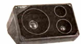
Composé d'une platine - design - dim. 245 x 147 mm, supportant les H.P., et fixée sur boîtier inférieur en forme de pupitre (hauteur tot. 142 mm). Equipement : 1 woofer 127 mm, 1 médium 64 mm, 1 tweeter à dôme, 1 filtre de séparation, réponse en fréq. 50 à 22.000 Hz, puissance max. admissible 100 WATTS, impéd. 4 ohms, présentation de haut standing.
