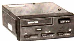
Lecteur stéréo pouvant recevoir tous types de cassettes (support magnét. Fe ou Cr), défil. 4,75 cm/s, pleurage < 0,3 %, puissance tot. 10 WATTS (2 x 5 W), contrôle de volume, tonalité, balance stéréo, touche combinée AVANCE rapide et EJECTION cassette, auto-stop fin de bande, sorties H.P. impéd. 4 ohms, alim. 12 Volts (- à la masse), L. 120, H. 48, P. 150 mm.
