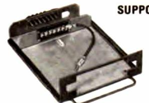
L'autoradio est monté sur un tiroir coulissant qui s'insère dans un support fixé à demeure dans ou sous le tableau de bord. Les raccords H.P., antenne et alimentation sont reliés à un connecteur mâle sur le tiroir, qui s'enfiche dans son équivalent femelle sur le support. Une poignée sur le tiroir permet le retrait de l'autoradio, pour le soustraire à toute « convolite » et sert également d'anse de portage. L. 195, H. 65, P. 215 mm.
