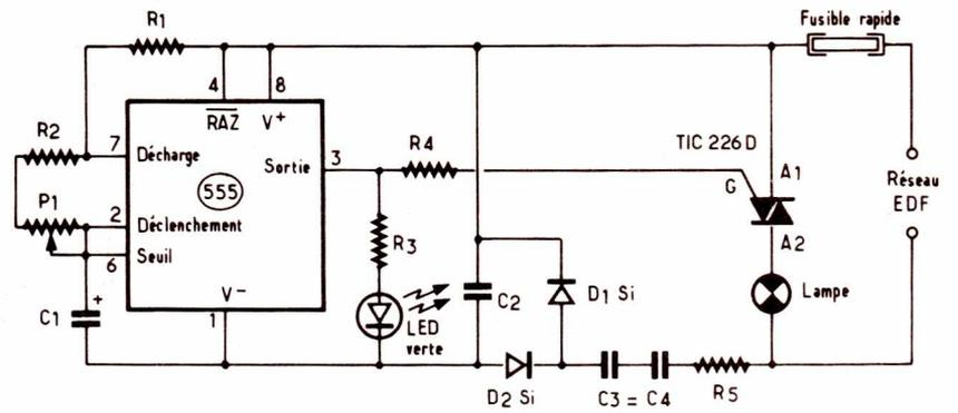
Figure 1 : Schéma de principe du clignoteur.
