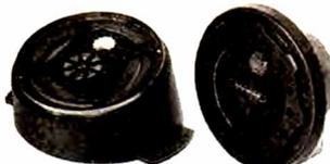
Ensemble 3 voies : boomer d. 155 mm, à suspension souple, médium d. 51 mm, tweeter d. 25 mm, filtre de séparation, réponse 50 à 20.000 Hz, puissance admissible 30 WATTS, impédance 4 ohms. Possibilité d'installation avec son boîtier (d. max. 185 mm), ou en encastré, en retirant l'embase (voir figure).
