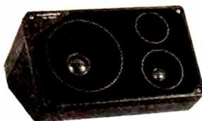
Composé d'une platine « design », dim. 245 x 147 mm, supportant les H.P., et fixée sur boîtier inférieur en forme de pupitre (hauteur tot. 142 mm). Equipement : 1 woofer 127 mm, 1 médium 64 mm, 1 tweeter à dôme, 1 filtre de séparation, réponse en fréq. 50 à 22.000 Hz, puissance max. admissible 100 WATTS, impéd. 4 ohms, présentation de haut standing.
