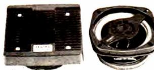
Système coaxial comprenant : 1 boomer 130 mm à ferrite magnétique au barium, membrane renforcée à suspension souple - 1 tweeter piézoélectrique d. 45 mm, réponse en fréq. 65 à 40 000 Hz (pour une puissance mini requise de 1 watt), distorsion < 0,1 %, puissance maximum admissible 75 WATTS rms, impéd. 4 ohms, profond. d'encastrement 54 mm, grille décor 158 x 158 mm, cordon 4 m.
