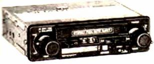
Récepteur GO-PO-FM mono et stéréo (MPX) avec C.A.F., voyant d'émissions stéréo, filtre parasites ANSS — Lecteur de toutes cassettes st., touche (blocable) d'AVANCE et RETOUR rapide de la bande et éjection cassette, éjection automat. fin de bande avec retour du son radio, commandes de volume, tonalité, balance stéréo, puiss. tot. 16 WATTS (2 x 8 W), impéd. H.P. 4 ohms, alim. 12 V (— à la masse), L. 178. H. 44. P. 135 mm.
