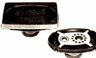
Comprend : 1 boomer elliptique 16 x 24, avec en position axiale 1 médium 8 cm + 1 tweeter 5 cm, réponse en fréquence 60 à 18 000 Hz, puissance maximum admissible 25 WATTS musicaux, impédance 4 ohms, profondeur d'encastrement 9 cm, grille décor amovible, cordon 3,5 m.
