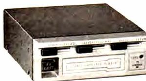
Lecteur stéréo pouvant recevoir tous types de cassettes (support magnétique Fe ou Cr), pleurage < 0,3 %, puissance totale 12 WATTS (2 x 6 W), contrôle de volume, tonalité, balance stéréo, touche combinée AVANCE rapide et EJECTION cassette, auto-stop fin de bande, sorties H.P. impéd. 4 ohms, alim. 12 volts (- à la masse), L. 120, H. 45, P. 135 mm.
