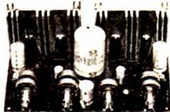
Entièrement câblé et pré-réglé. Dim. 185x124x65 mm. Equipé des commandes vol., gr., aig., bal. et du circuit d'alim. (redresseur + filtres). Aliment. en 2 x 39 V altern., entrée (P.U. cristal ou tuner) 200 mV. Rép. à 40 à 50 000 Hz. Distors. 0,5 %. Impéd. de sortie 8 à 16 ohms. Prix ..... 186,00 F
