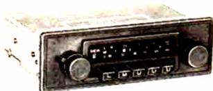
Récepteur GO - PO - FM (mono), doté d'un clavier pour présélection de 5 stations (à répartir sur les 3 gammes), puissance 5 WATTS, alimentation 12 Volts (— à la masse), dimensions : L. 165. H. 45. P. 150 mm - Livré avec 1 H.P. 12 cm, 4 ohms + balle.
