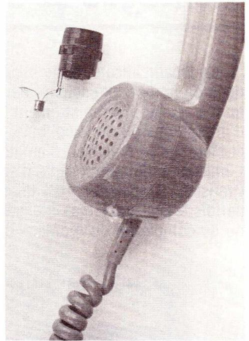
Ces préamplis permettent de remplacer directement les micros à charbon par d'excellentes pastilles dynamiques ou piézo-électriques.
