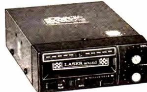
Lecteur de cassette stéréo doté d'une rampe lumineuse frontale qui scintille à la cadence musicale ; peut recevoir tous types de cassettes (support magnét. Fe ou Cr), pleurage < 0,3 %, rapport S/B > 50 dB, puissance tot. 40 WATTS (2 x 20 W), contrôle de volume et tonalité, filtre de fréq. L/H, balance stéréo, touche combinée AVANCE rapide et EJECTION cassette, auto-stop fin de bande, sorties H.P. impéd. 4 ohms, alim. 12 volts (- à la masse), L. 120, H. 46, P. 155 mm.
