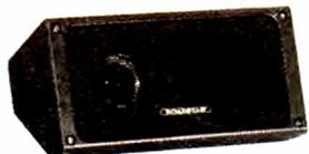
Composé d'une platine « design », dim. 225 x 115 mm, supportant les H.P., et fixée sur boîtier inférieur en forme de pupitre (hauteur tot. 117 mm). Equipement : 1 woofer 102 mm, 1 tweeter à dôme, 1 filtre de séparation, réponse en fréq. 50 à 22.000 Hz, puissance max. admissible 60 WATTS, impéd. 4 ohms, présentation de haut standing.
