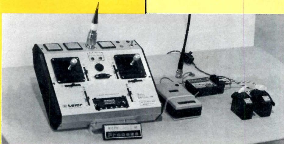
La radio « Absolue ». Synthèse de fréquence, signature radio pour la personnalisation de l'émission et évation de fréquence.
