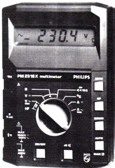
gammes résistances jusqu'à 100 MΩ avec une résolution maximale de 100 mΩ.
