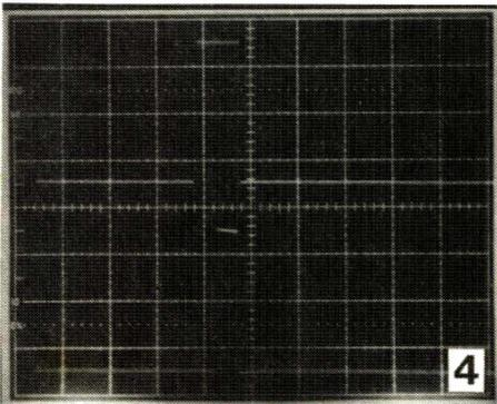
4 Trace supérieure synchro composite 2 V, 5  $\mu$ s/div.
