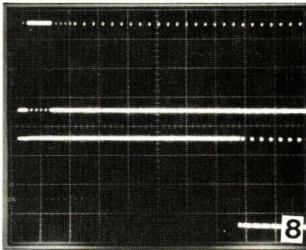
8 Trace supérieure synchro composite 2 V, 200  $\mu$ s/div.
