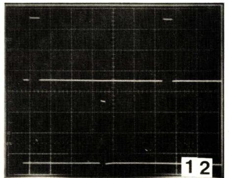
12 Trace supérieure synchro composite 2 V, 10  $\mu$ s/div.
