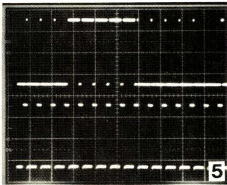
5 Trace supérieure synchro composite 2 V, 50  $\mu$ s/div.
