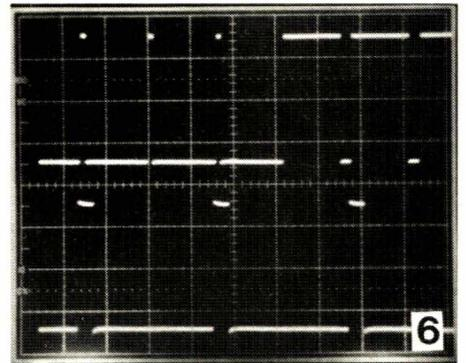
6 Trace supérieure synchro composite 2 V, 20  $\mu$ s/div.
