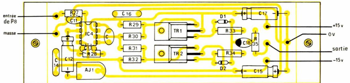
Figure 10 l'amplificateur de ligne. CI et implantation (prévoir 2 exemplaires).
