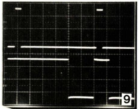
9 Trace supérieure synchro composite 2 V, 10  $\mu$ s/div.
