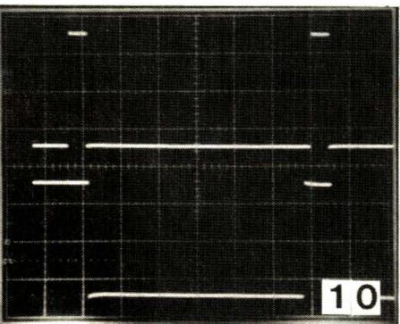
10 Trace supérieure synchro composite 2 V, 10  $\mu$ s/div.
