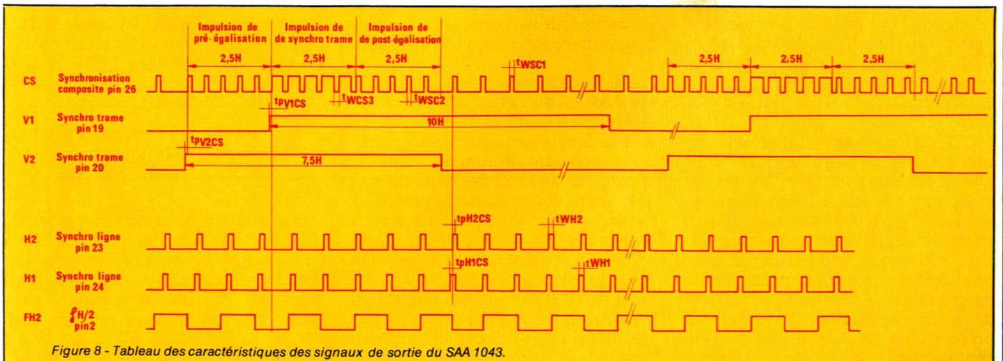
Figure 8 - Tableau des caractéristiques des signaux de sortie du SAA 1043.
