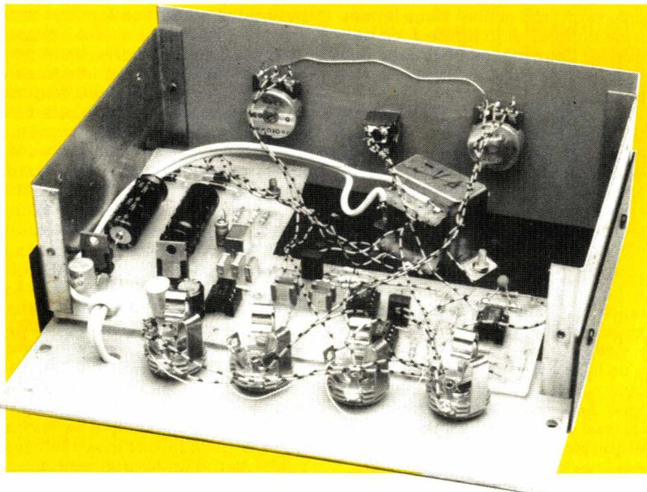
passifs avec l'obligation de tenir compte des courbes d'impédance en fonction de la fréquence avec les problèmes d'adaptation que cela suppose. C'est dans cette optique de mise au point d'enceintes que nous avons d'ailleurs incorporé un générateur de bruit rose au FA 2.
