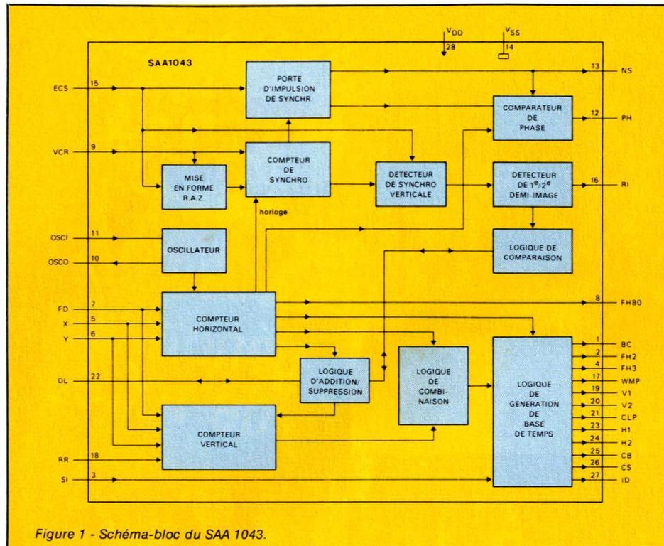
Figure 1 - Schéma-bloc du SAA 1043.
