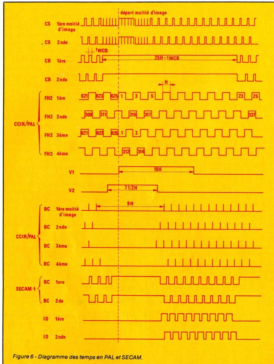
Figure 6 - Diagramme des temps en PAL et SECAM.
