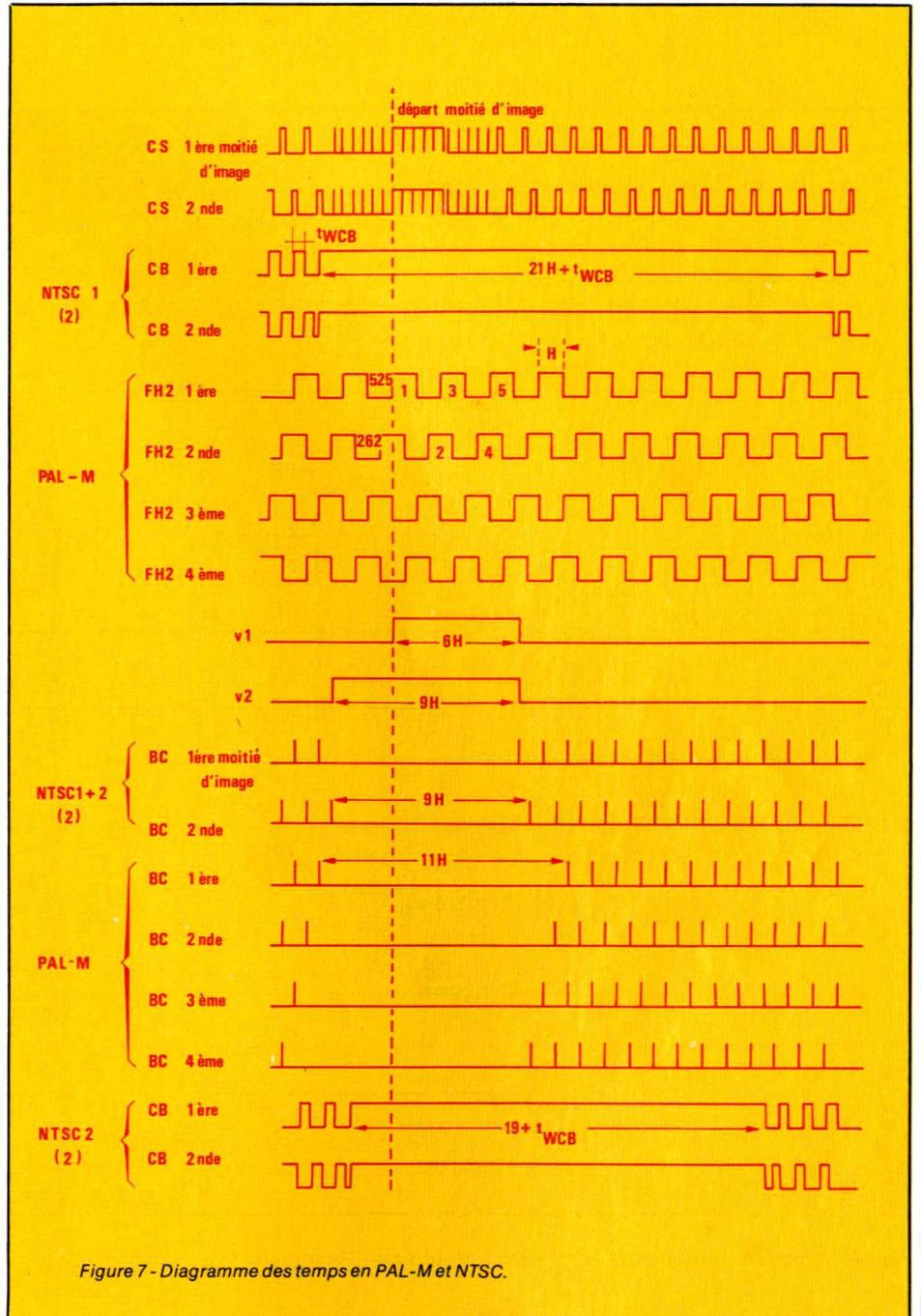
Figure 7 - Diagramme des temps en PAL-M et NTSC.
