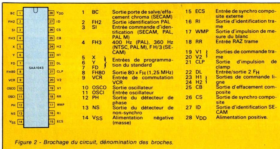
Figure 2 - Brochage du circuit, dénomination des broches.
