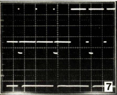
7 Trace supérieure synchro composite 2 V, 20  $\mu$ s/div.
