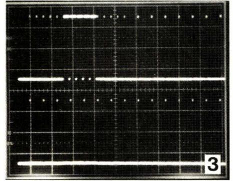
3 Trace supérieure synchro composite 2 V, 100  $\mu$ s/div.
