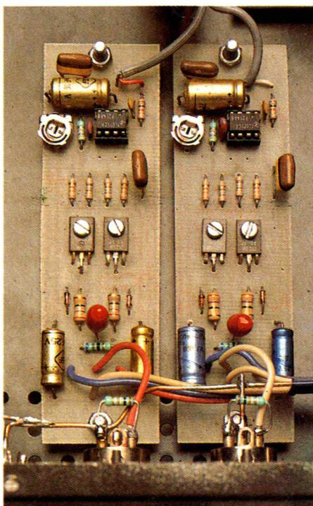
Sortie du curseur de  $P_8$ , la modulation est confiée à l'amplificateur de ligne constitué de  $IC_4$ ,  $TR_1$  et  $TR_2$ , ainsi que leurs éléments associés.
