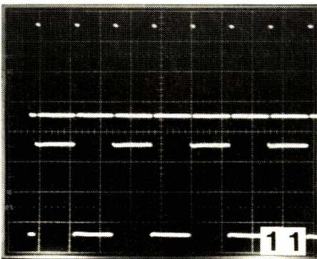
11 Trace supérieure synchro composite 2 V, 50  $\mu$ s/div.
