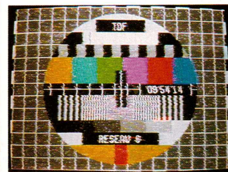
Dans les mêmes caractéristiques de pointage, la tête précédente a été remplacée par un convertisseur ayant un facteur de bruit donné de 1.8 dB. Le gain visuel est fort appréciable (PROSAT SYSTEME)
