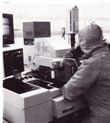
Positionnement des masques sur une plaque.
