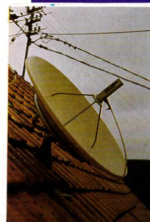
Parabole 88 cm FID : 0,32 Gain \approx 38,5 dB (12,75Ghz) typique — PORTEX — CONVERTISSEUR F.b : 2,5 dB réel (mesuré) — PORTENSEIGNE —
