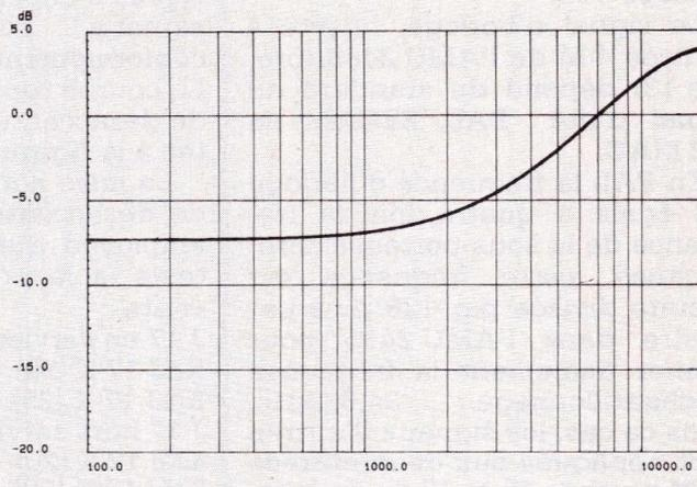
Figure 15 - Courbe de précompensation 50  $\mu$ s.
