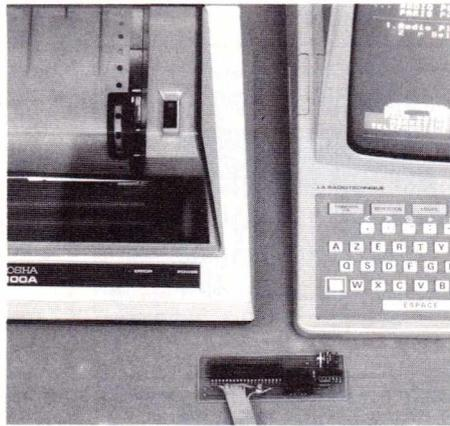
Comme la dernière fois, notre horloge n'est qu'un simple multi-vibrateur CMOS réglé sur 19200 Hz pour 1200 bauds (52  $\mu$ s à l'oscilloscope) : c'est beaucoup plus économique qu'un classique générateur de bauds à quartz et diviseur, et tout à fait assez stable en environnement domestique si les composants RC sont de bonne qualité.
