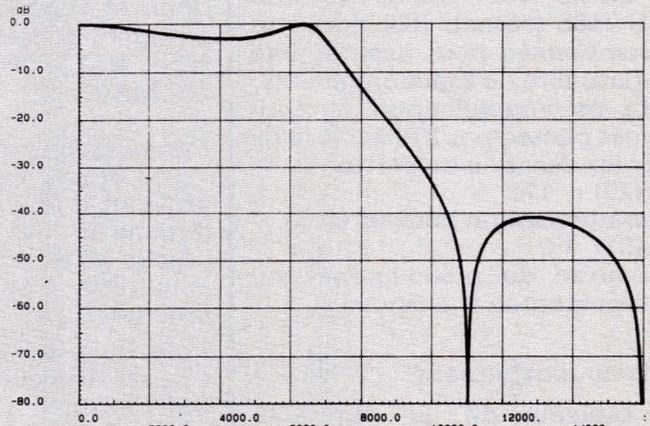
Figure 12 - Courbe de réponse des filtres de surechantillonnage.
