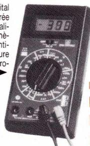
**5010 EC.** Multimètre digital 2000 points. Impédance d'entrée 10 MΩ. Précision 0,25 %. 24 calibres. Transistormètre. Capacimètre. Thermomètre. Test de continuité sonore. Test diode. Mesure de conductance. Calibre 10 A. Protection par fusible.
