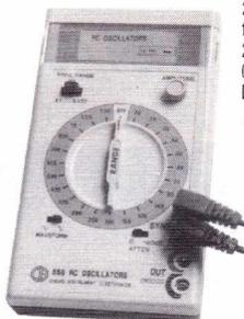
**555 RC.** Générateur portable de 20 Hz échelonnées en 46 fréquences fixes. Sinus et carré. Atténuateur - 20 dB. Taux de distorsion à 15 kHz : 0,05 % à 150 kHz : 0,3 %.
