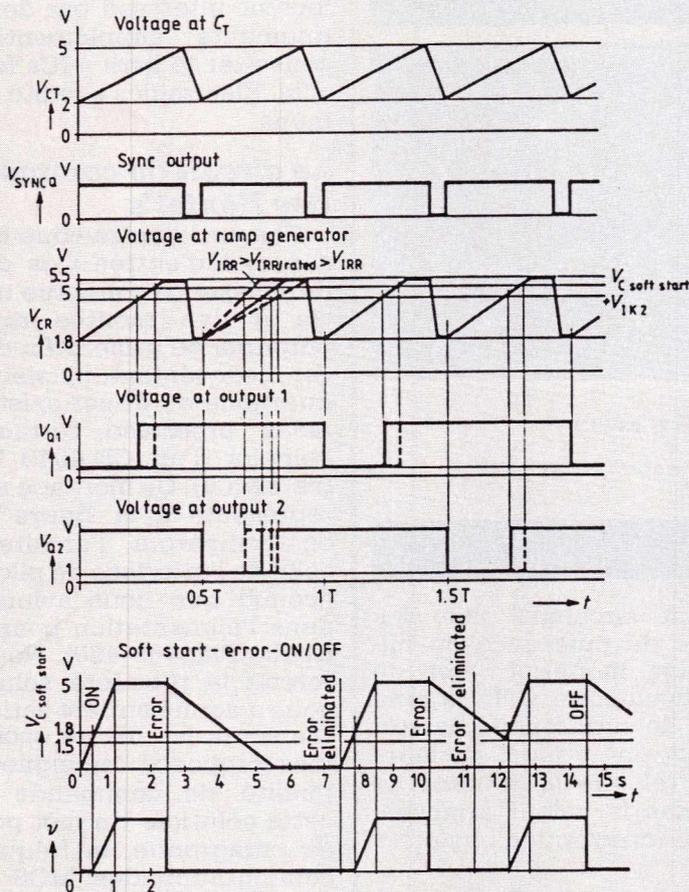
valeur de 5 volts. En fait, le potentiel de la rampe délivré par son générateur peut monter jusqu'à 5,5 volts. Ainsi, en modifiant la pente de la dent de scie, on peut limiter comme l'on veut la valeur maximum du rapport cyclique de sortie. Ceci se retrouve illustré par la troisième courbe ( $V_{cr}$ ) dessinée parmi les chronogrammes de la **figure 11**.
