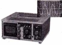
Bande passante : 10 Mhz, sensibilité de 10 mV à 10 V en 10 positions, base de temps de 0,3 µS à 0,3 S/carreau, impédance d'entrée : 1 MOhm/32 pF, trigger interne/externe, fonction d'intégration du trigger sur impulsion TV, polarité du trigger commutable, dim: 258x130x180, poids : 4,5 Kg.
