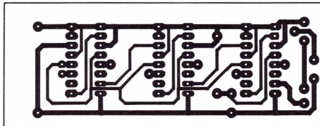
Figure 7 : Tracé du circuit imprimé décodeur de numéro
