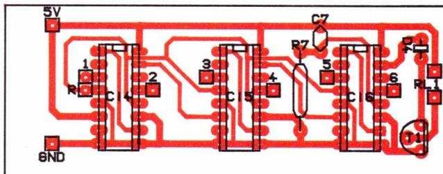
Figure 8 : Implantation des composants du décodeur de numéro.
