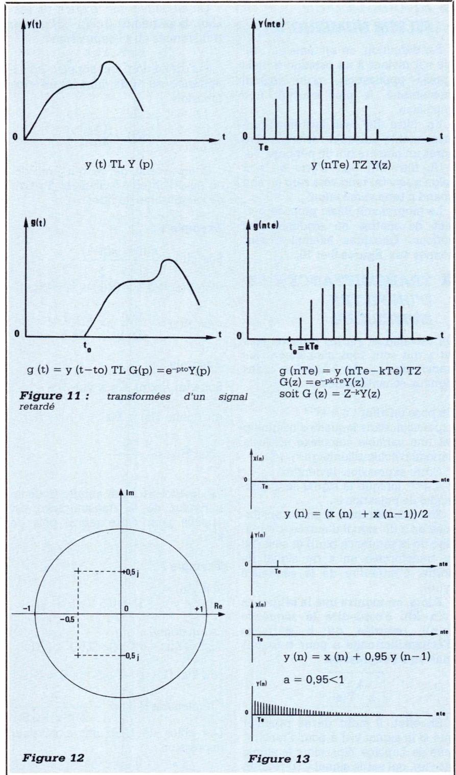
mais, pour l'exemple 2, le filtre sera stable si le coefficient  $a$  est inférieur à 1 et sera instable si  $a$  est égal ou supérieur à 1.
