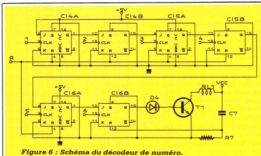
Figure 6 : Schéma du décodeur de numéro.
