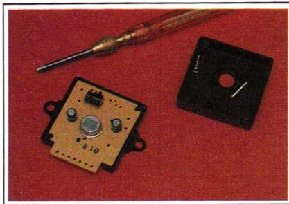
pour que les performances annoncées soient obtenues : c'est une affaire de dixième de millimètre ! Fort heureusement, il est proposé aussi un boîtier plastique « GIL-BOX », spécialement étudié pour recevoir les lentilles et un circuit imprimé supportant le MS 02 : c'est l'ensemble de ces trois éléments de base que nous allons mettre à contribution dans cette étude.
