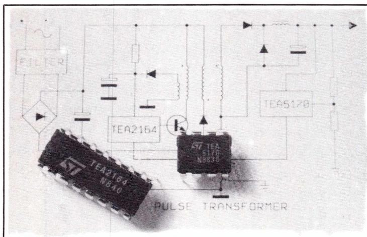
Du côté primaire, le TEA 2164 esclave fournit directement le courant de  $\pm 1,5$  A au transistor de commutation relié à l'enroulement primaire du transformateur d'alimentation. Du côté secondaire, le TEA 5170 maître contrôle la sortie filtrée et génère des signaux de commande pour le TEA 2164. Un couplage des circuits primaire et secondaire ne requiert qu'un petit transformateur d'impulsions à faible coût.
