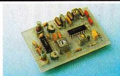
**Un récepteur VHF à double changement de fréquence** : plus délicate à mettre au point que la technique de l'hétérodyne simple, celle du double changement permet la réalisation de récepteurs plus sensibles.
