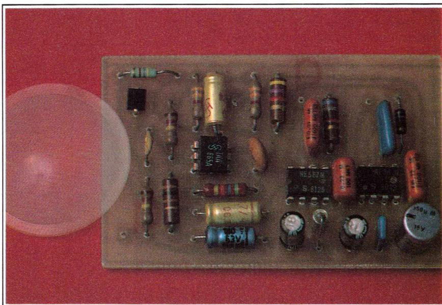
Les trois connexions (masse, alimentation et sortie), seront naturellement exécutées avant collage, à l'aide de fils souples de 15 à 20 mm de long : veillez bien au respect du brochage !
