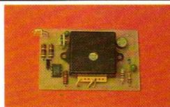
**Une alarme infrarouge "intégrale"** : développé à partir d'un kit à capteur passif, ce détecteur faible consommation transmet ses informations à une centrale déportée, par infrarouges bien-sûr !
