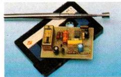
**Commande d'enregistrement pour scanner** : ce petit montage simple vous permettra de surveiller le trafic tout en n'étant pas constamment à l'écoute.
