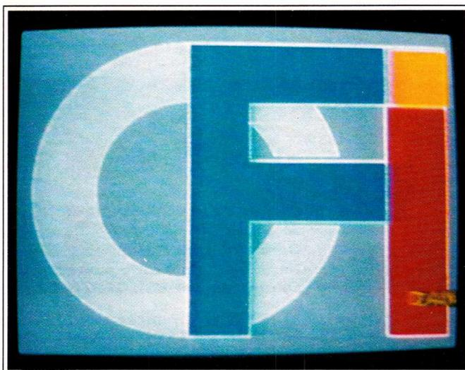
Réception avec une parabole de 2,40 m de Ø PIRE : Réception à Abidjan avec une parabole de 3,00 m de Ø. PIRE  $\approx 30$  dBW.
