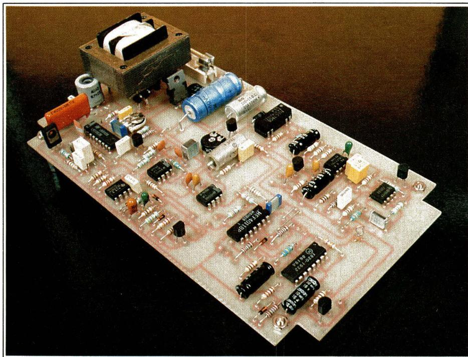
Après avoir détaillé le fonctionnement du LM 1893 et les contraintes imposées par une transmission sur le réseau dans notre précédent numéro, nous abordons ce mois-ci le schéma et la réalisation pratique de notre interphone à commutation « vox ».
