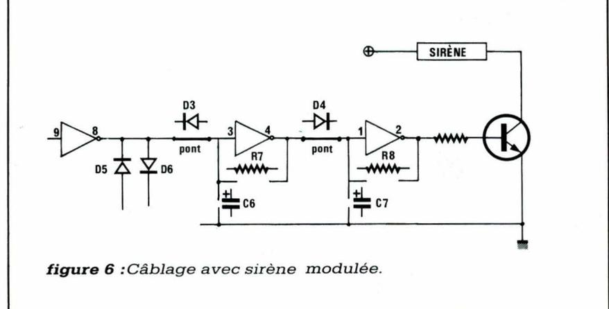
**figure 6** : Câblage avec sirène modulée.
