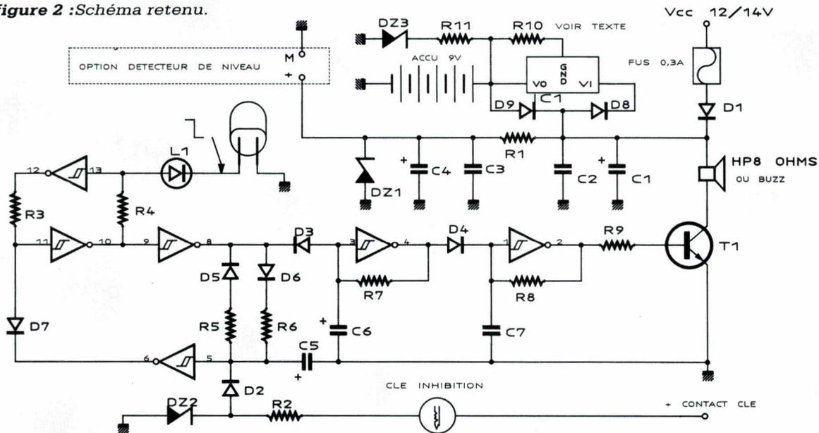
état stable avec  $T_1$  bloqué, mais cette fois-ci « sensible » à l'état du point (C) (capteur de position). C'est l'état de veille. En effet, un niveau  $V_{ss}$ , même fugitif, en (C) fait basculer la sortie de D, qui se verrouille à  $V_{dd}$ , et, via les portes B et C, sature  $T_1$ . La sortie (S) est active à  $V_{ss}$  : Il y a une alarme grâce à un dispositif d'alerte inséré entre  $V_{dd}$  et (S).
