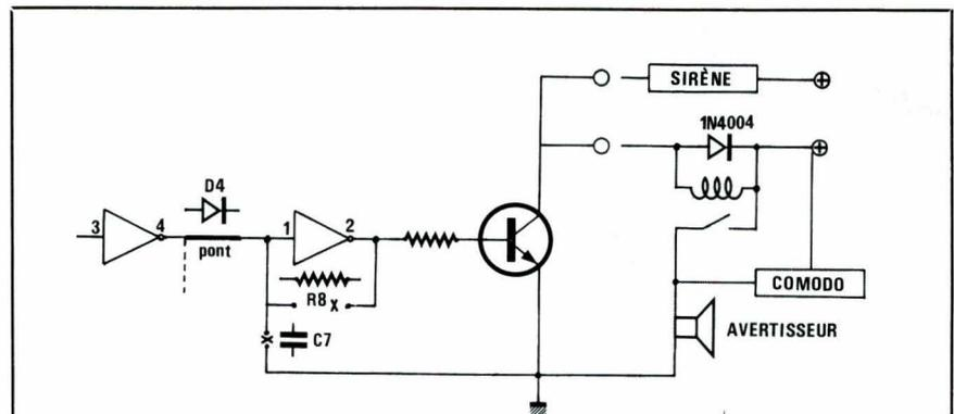
**figure 5** : Câblage pour l'utilisation de l'avertisseur sonore sur relais polarisé ou d'une sirène non modulée mais avec oscillateur intégré.
