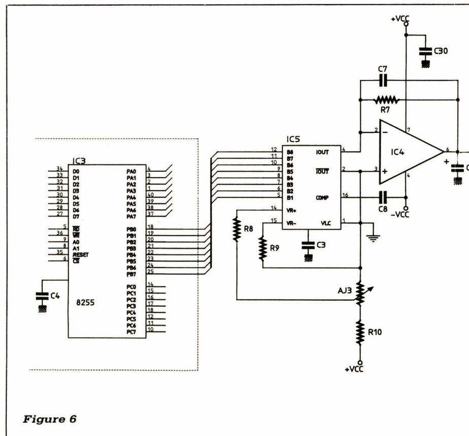
4. lancer TEST-AD tapé le mois dernier et ajuster AJ<sub>3</sub> pour obtenir +510 mV en TP<sub>2</sub>.
