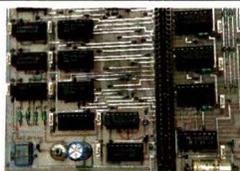
**AC Divid** : une carte qui, connectée ou non dans le rack A/D, permettra d'obtenir, en parallèle ou individuellement, 32 fréquences espacées d'un tiers d'octave.
