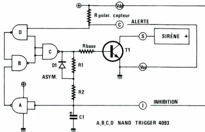
figure 2 : Schéma retenu.
