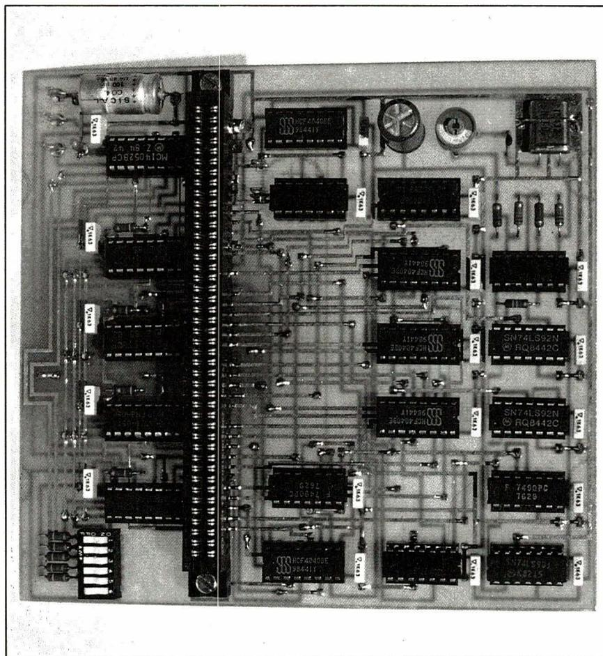
La carte qui vous est proposée ici résout un problème délicat : obtenir 32 fréquences allant de 20 Hz à 25 kHz, espacées d'un tiers d'octave environ, et pilotées par un seul et unique quartz.
