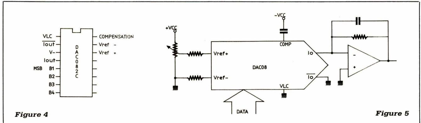
che de compensation (qu'il est préférable de relier au moyen d'un condensateur à  $-V_{cc}$  plutôt qu'à la masse pour des raisons de bruit), une broche VLC qui permet l'adaptation à plusieurs technologies (TTL, MOS, PMOS, etc.) en y connectant un réseau approprié, et enfin  $I_o$  et  $I_o$  barre, sorties en courant complémentaires autorisant des liaisons symétriques avec le convertisseur courant/tension.
