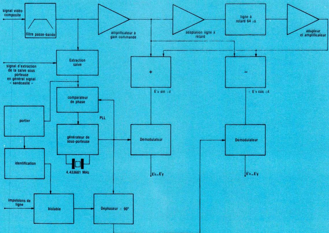
Figure 7 : synoptique décodeur PAL.
