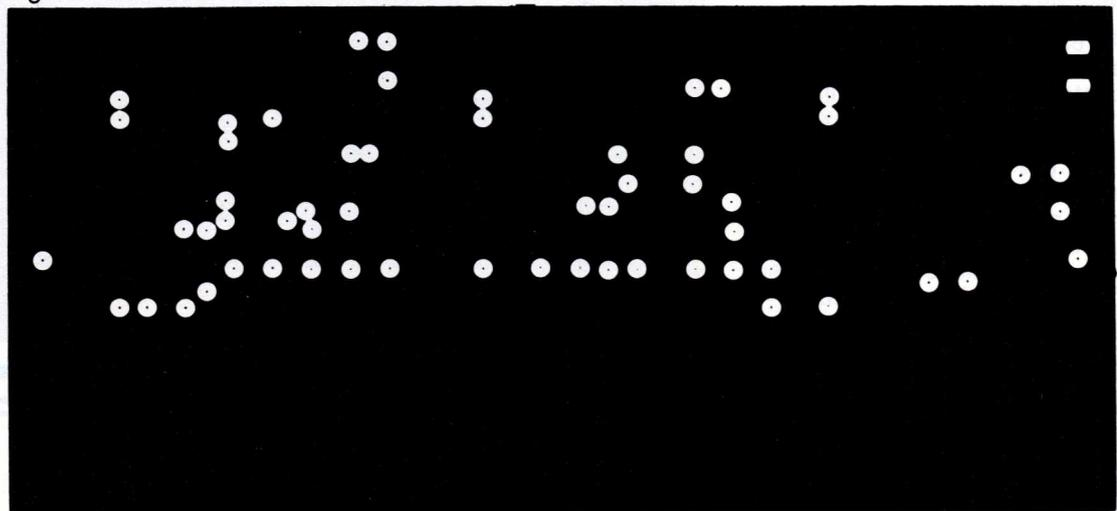
Figure 8 : Plan de masse côté composants.
