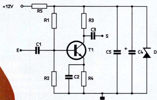
transistor IBSR 13 émetteur - commun, monté en amplificateur apériodique de gain -  $s$   $R_3$  où  $s$  représente la pente ou transconductance du transistor (variable
