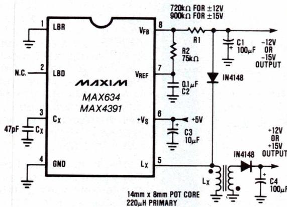
Figure 12 : Convertisseur ± 12 V à ± 18 V.
