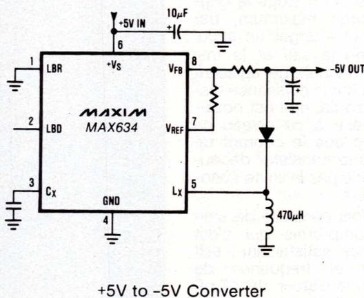
Figure 5 : Convertisseur + 5 V  $\rightarrow$  - 5 V avec le MAX 634.
