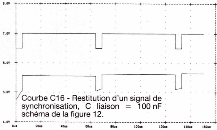
Courbe C16 - Restitution d'un signal de synchronisation, C liaison = 100 nF schéma de la figure 12.
