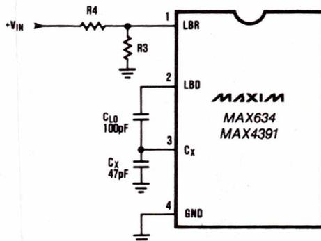
Assez voisin, le schéma de la **figure 16** permet d'élever la tension de sortie autant que le MOSFET peut le supporter.
