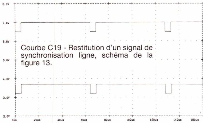
Courbe C19 - Restitution d'un signal de synchronisation ligne, schéma de la figure 13.
