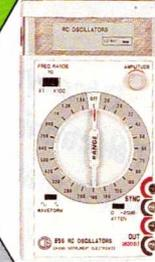
Générateur portable de 20 Hz à 150 kHz échelonnées en 46 fréquences fixes. Sinus et carré. Atténuateur - 20 dB. Taux de distorsion à 15 kHz : 0,05 % à 150 kHz : 0,3 %. Dim. : 150 x 82 x 21 mm
