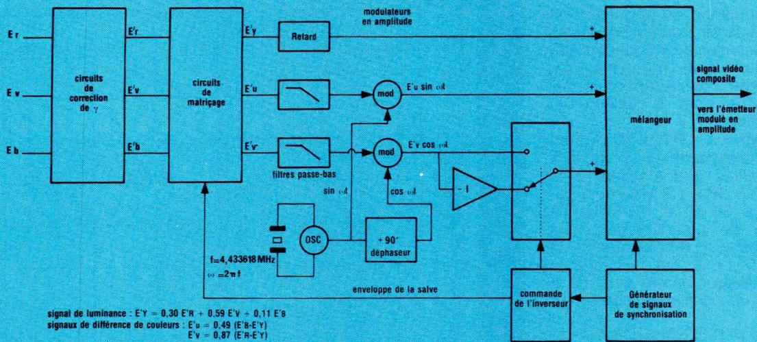
Figure 3 : synoptique d'un codeur PAL.
