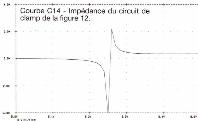
La courbe d'impédance montre les défauts du système. Lorsque la tension d'entrée est inférieure au point de réalignement, le circuit débite dans la source. Au-delà du point de réalignement à 5,25 V environ, l'impédance est assez élevée : environ 330 k $\Omega$ , ce qui est suffisant pour ne pas perturber le signal incident. Les résultats en régime transitoire sont donnés aux trois courbes suivantes : C15, C16, et C17.
