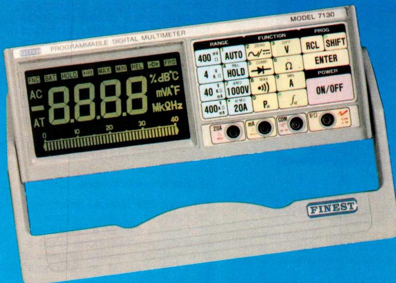
**Spécifications :** 4000 points - Précision 0,2 % DC. Affichage LCD géant 95x54 mm, caractères 23 mm. Bar-graph 41 segments avec échantil. 20 cycles/s. Calibre automatique ou manuel. Interface RS 232. Calibre 20 A. Fonctions mathématiques Min/Max, Rel. Diff. % Comp. Fréquence jusqu'à 40 Khz. Wattmètre (tension x courant). Data hold. Test diode et continuité. Dimensions : 214x83x269 mm. Alimentation : 220V.
