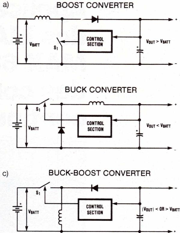
Figure 1 : Les différentes configurations de convertisseurs DC-DC.
