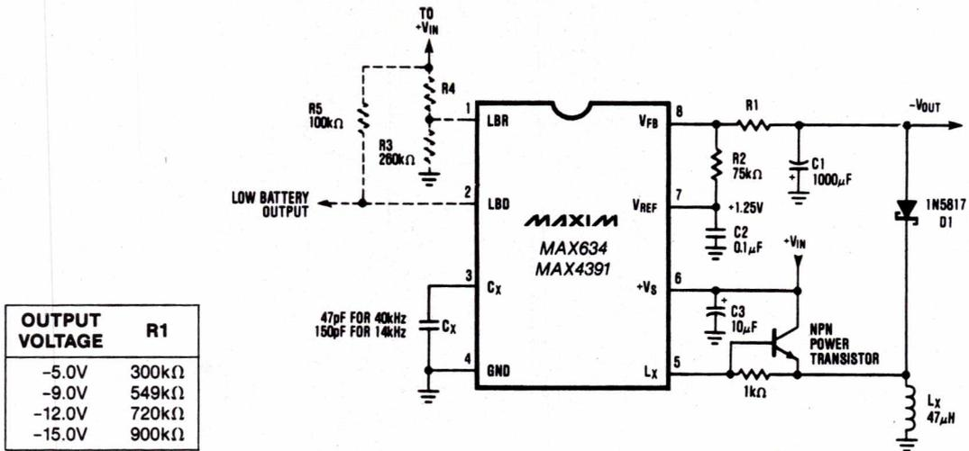
Figure 14 : Augmentation de la puissance disponible avec un transistor NPN externe.
