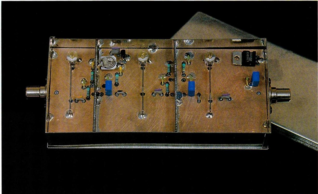
*Prévu pour les cas de réception difficile de la 5 et 6<sup>e</sup> chaîne, ce préampli à faible bruit pourra, moyennant modification des valeurs des éléments accordés, convenir aux situations les plus diverses. Toutefois s'agissant d'un préamplificateur sélectif, sa mise en œuvre nécessite l'emploi de coupleurs de bande ; on ne pourra donc pas le monter directement en insertion sur une installation individuelle, sous peine de détériorer la réception des canaux hors bande.*
