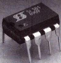
SILICONIX propose un nouvel amplificateur de gain unité bouclé pour l'aiguillage et la commutation des signaux à large bande. Le nouvel amplificateur Si 581 est destiné à être utilisé avec les CI vidéo ou à large bande passante D/CMOS de la société (multiplexeurs DG 53x et commutateurs DG 54x). Ces CI vont améliorer les performances des systèmes à large bande tout en diminuant le nombre de composants, simplifiant la conception des circuits et réduisant les coûts.
