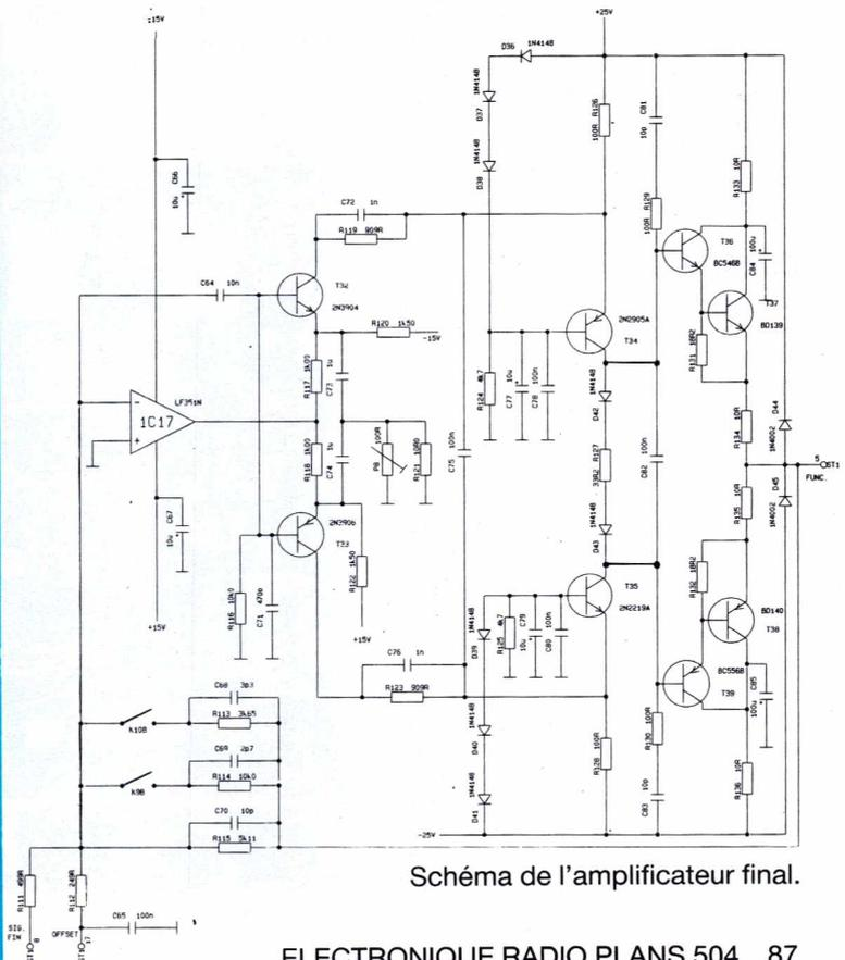
Schéma de l'amplificateur final.
