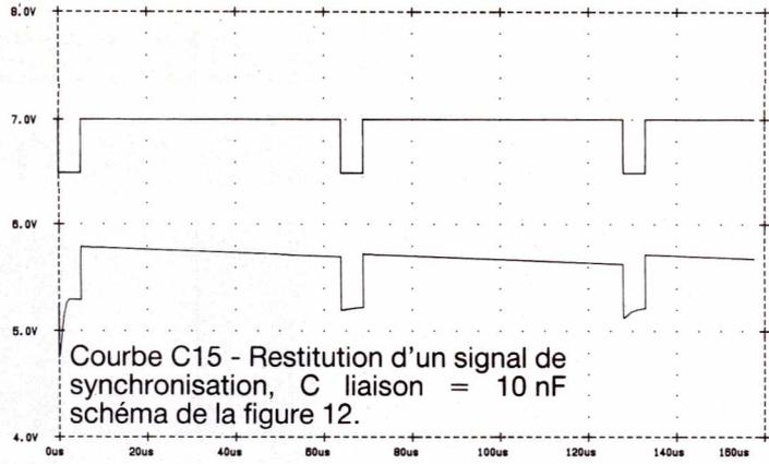
Courbe C15 - Restitution d'un signal de synchronisation, C liaison = 10 nF schéma de la figure 12.
