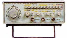
Générateur de fonctions de 0,2 Hz à 2 MHz en 7 calibres. Sinus, Triangle, Carré, TTL. Impulsion rampe. Sinusoïde étalée. Entrée VCF. Générateur d'impulsions. Générateur à balayage.
