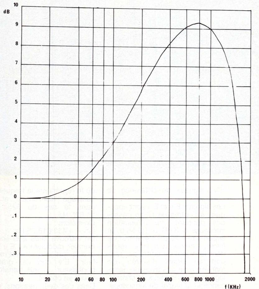
Figure 5 : courbe de préaccentuation et limitation en SECAM.
