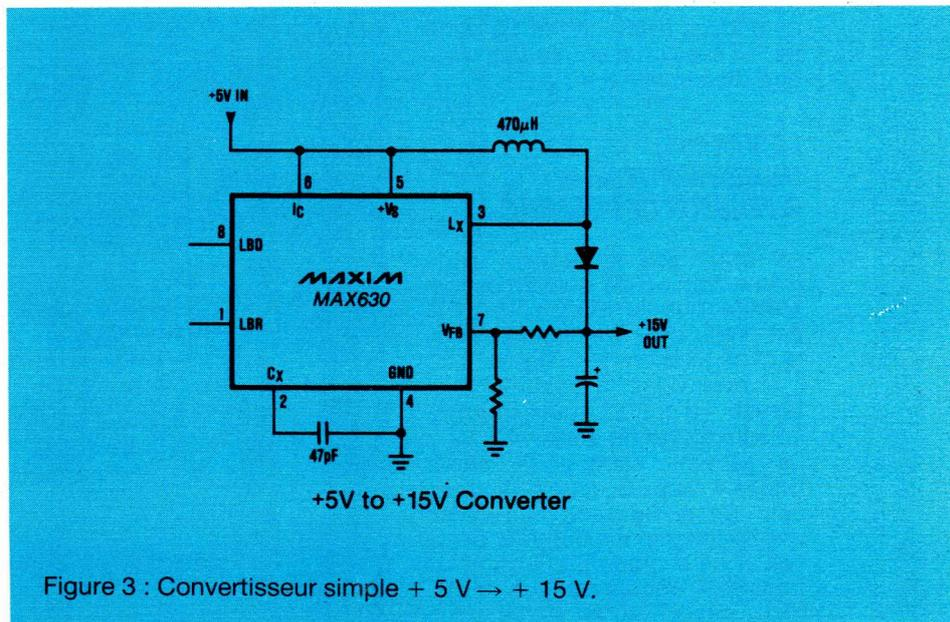
Figure 3 : Convertisseur simple + 5 V  $\rightarrow$  + 15 V.
