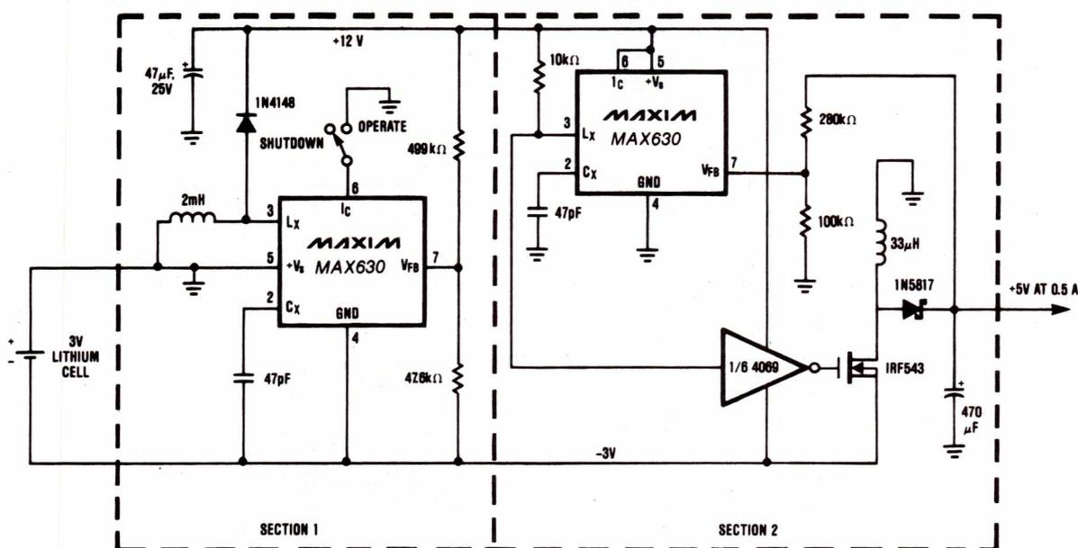
Figure 7 : Convertisseur forte puissance 3 V → 5 V avec position d'attente.
