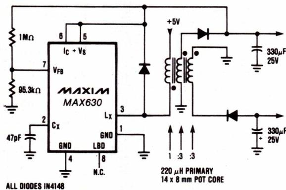
Figure 6 : Convertisseur + 5 V → ± 15 V avec le MAX 630.
