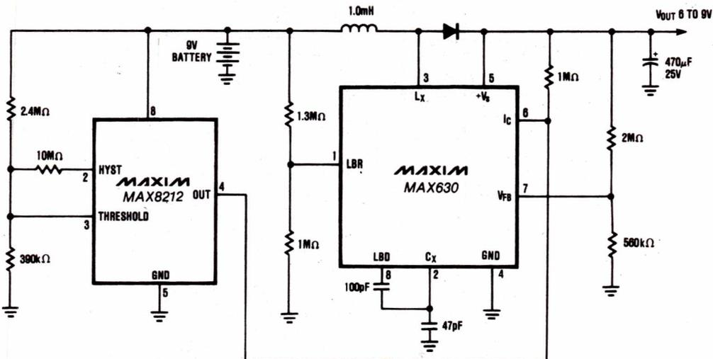
Figure 10 : Fonctionnement avec extension de la durée de la pile (jusqu'à 3 V).
