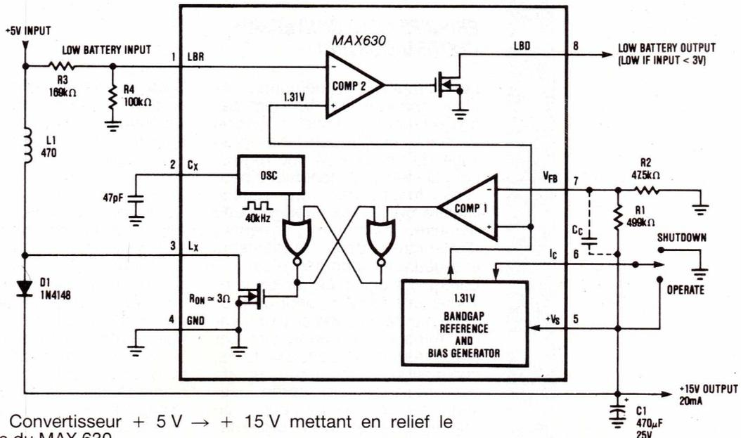
Figure 2 : Convertisseur + 5 V → + 15 V mettant en relief le synoptique du MAX 630.
