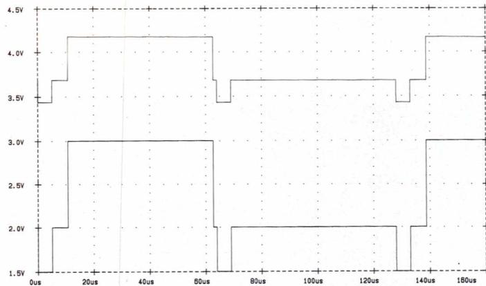
Courbe C20 - Restitution d'un signal vidéo alterné ligne noire/blanche schéma de la figure 13
