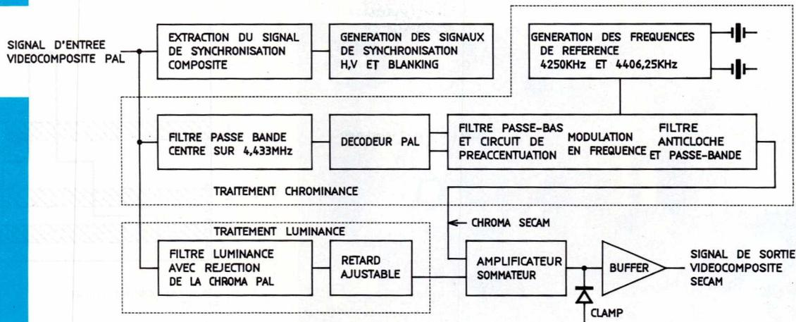
Figure 9 : synoptique du transcodeur.
