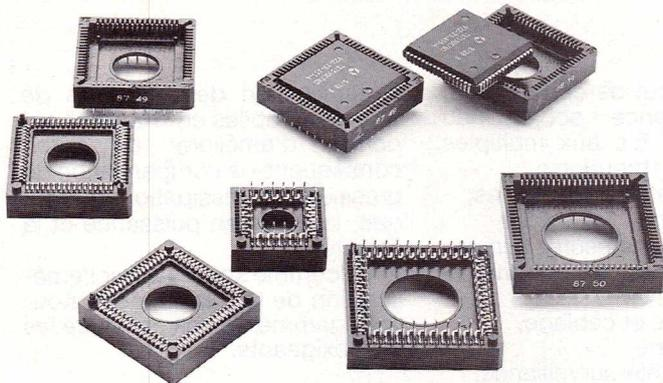
SOURIAU renforce sa gamme de supports de chip carriers plastique (PLCC) réf. 8604 avec le brochage 52 contacts. Cette série (JEDEC M0047) se compose donc maintenant des versions 44, 52, 68 et 84 contacts. De plus, un support de chip carrier rectangulaire de 32 contacts est actuellement en cours de développement et viendra com-
