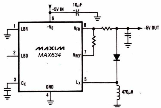
Figure 17 : Convertisseur à large plage de tension d'entrée opérant en oscillateur à fréquence variable.
