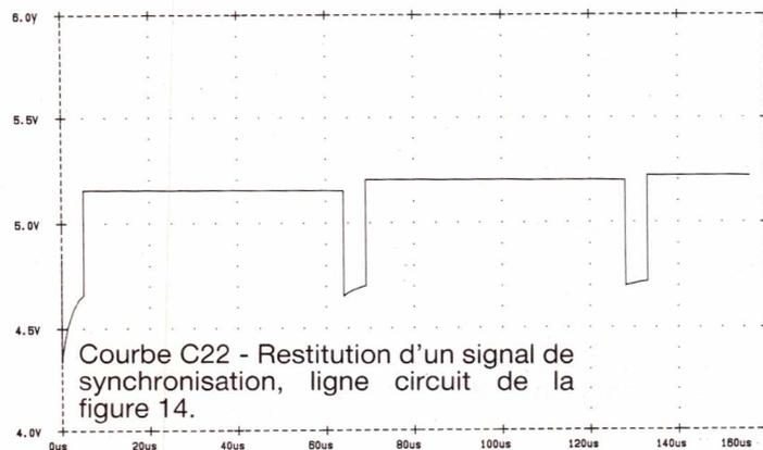
Courbe C22 - Restitution d'un signal de synchronisation, ligne circuit de la figure 14.
