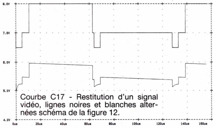
Courbe C17 - Restitution d'un signal vidéo, lignes noires et blanches alternées schéma de la figure 12.
