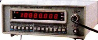
Fréquencemètre de 1 Hz à 1000 MHz. Sensibilité 15 mV. 2 canaux d'entrée. Affichage LED à 8 digits. Mesure de fréquences, périodemètre, totalisateur et contrôle interne.
