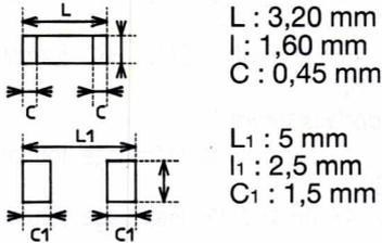
Pour implanter les résistances, nous avons besoin de deux pavés de  $2,5 \text{ mm} \times 1,5 \text{ mm}$  par résistance. Pour leur confection, nous utiliserons de la bande polyester rouge large de  $1,57 \text{ mm}$  (référence MECANORMA : 228 1008) et nous en couperons des bouts de  $2,5 \text{ mm}$ .
