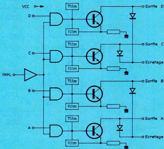
Figure 2 : Structure interne du CA 3262 mettant en évidence les protections.
