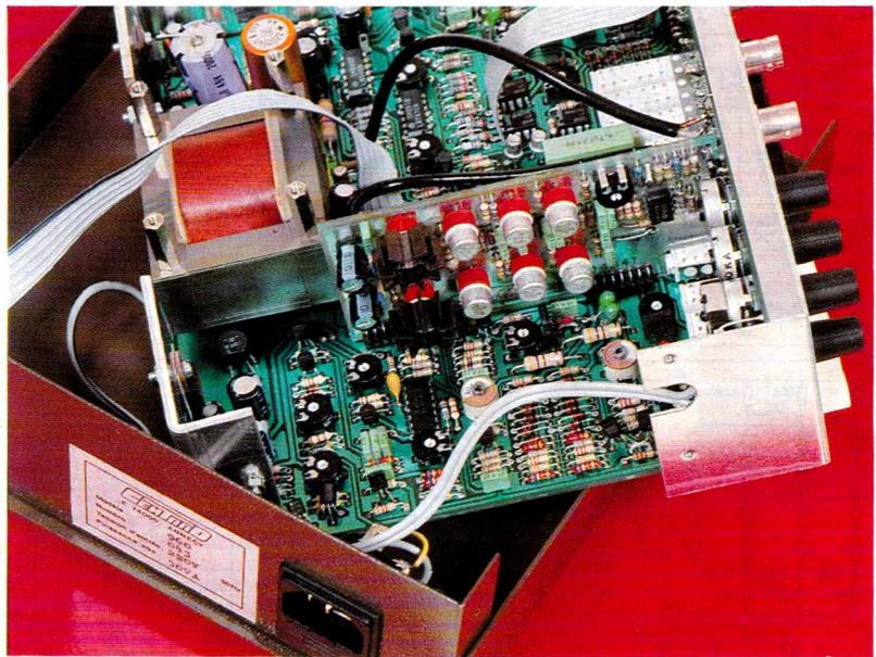
Autre vue à cœur ouvert dévoilant l'amplificateur de sortie placé verticalement.
