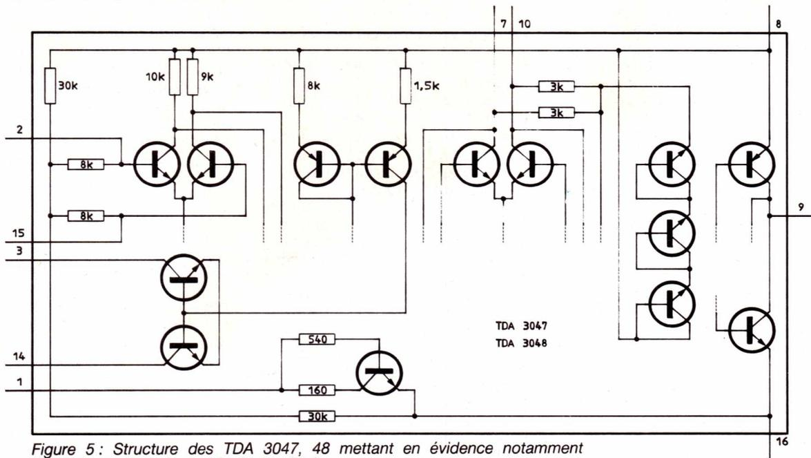
Figure 5: Structure des TDA 3047, 48 mettant en évidence notamment l'impédance d'entrée de 16 kΩ et le CAG.
