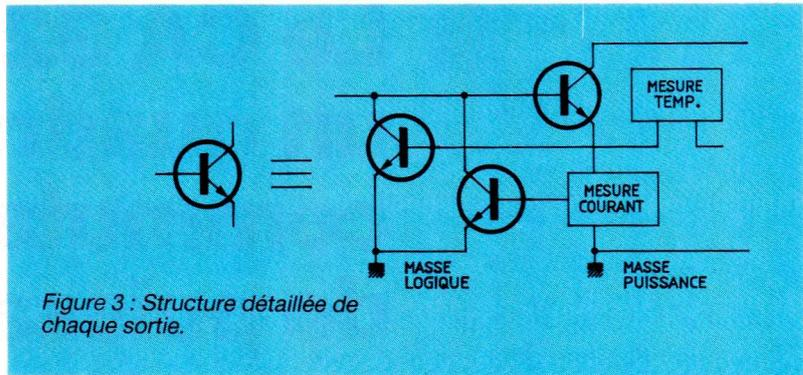
Figure 3 : Structure détaillée de chaque sortie.
