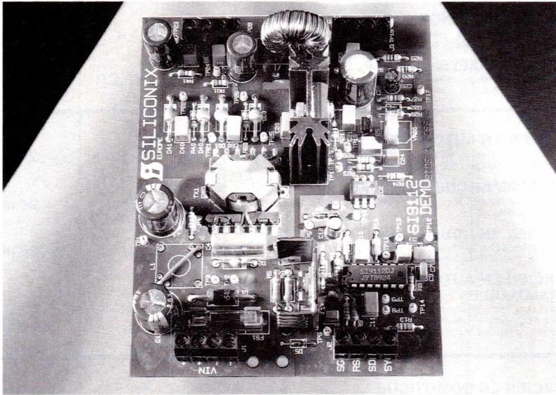
L'alimentation, fonctionnant à 200 kHz, possède trois sorties et délivre 50 watts avec un rendement de 80 %. Fournie montée et testée, elle ne comporte pas moins de 28 points de mesure accessible à des sondes oscilloscopiques.
