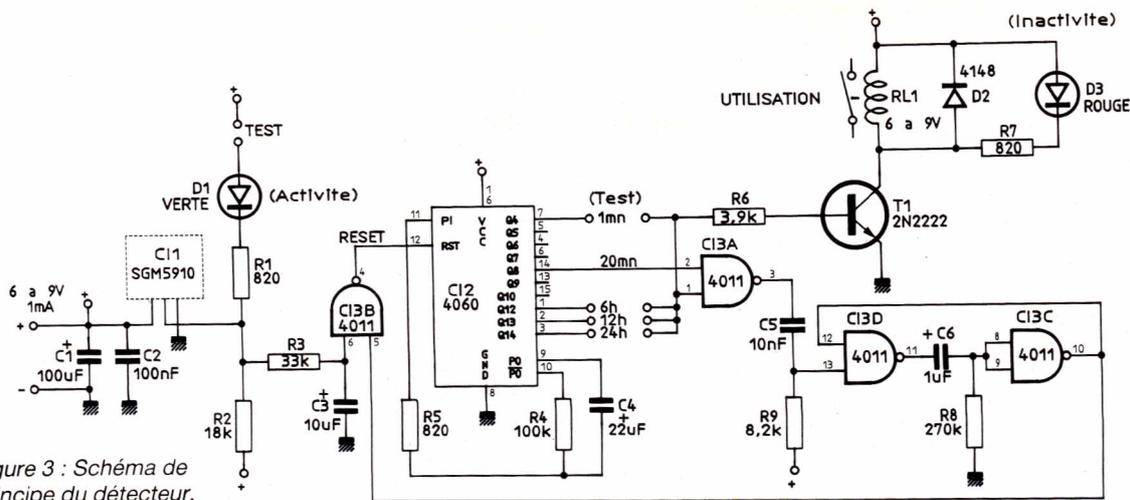
Figure 3 : Schéma de principe du détecteur.
