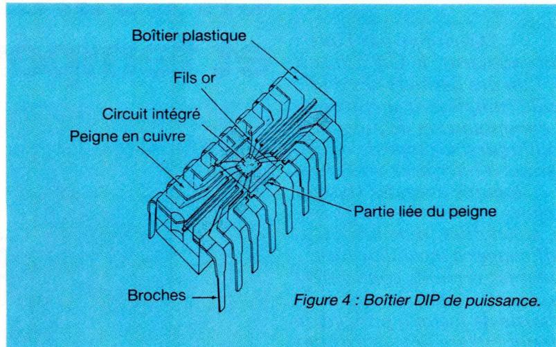
Figure 4 : Boîtier DIP de puissance.
