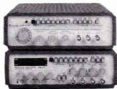
Le générateur de fonctions FG2AE avec ses 7 échelles de fréquences (0,02 à 2 MHz) est particulièrement convivial et est destiné à toutes applications concernant les systèmes audio, les ultra-sons et circuits utilisant des fréquences inférieures à 2 MHz.
