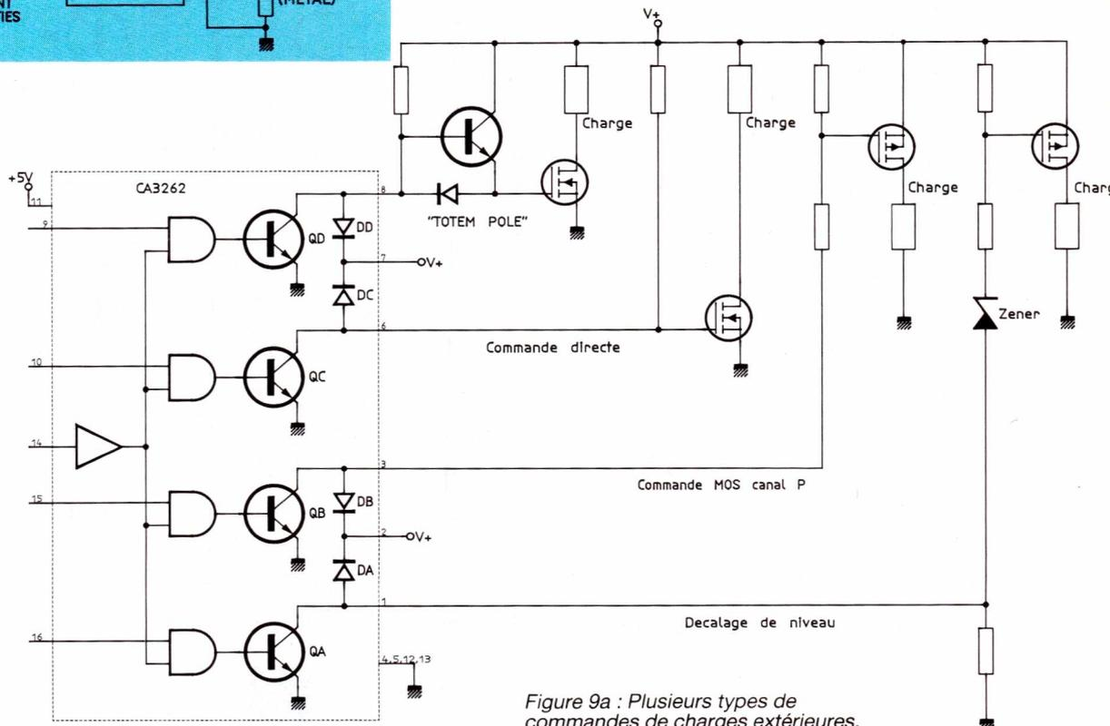
Figure 9a : Plusieurs types de commandes de charges extérieures.
