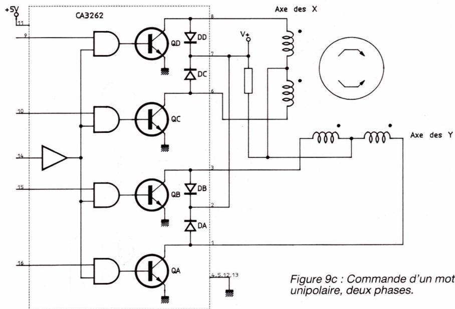
Figure 9c : Commande d'un moteur unipolaire, deux phases.
