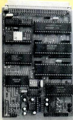
Des ports à revendre, un CAN, une interface série compatible PC et tout cela sur une surface de 160 x 100 mm<sup>2</sup>.
