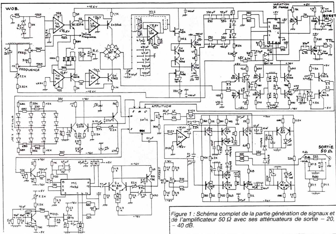
Figure 1 : Schéma complet de la partie génération de signaux et de l'amplificateur 50 Ω avec ses atténuateurs de sortie - 20, - 40 dB.
