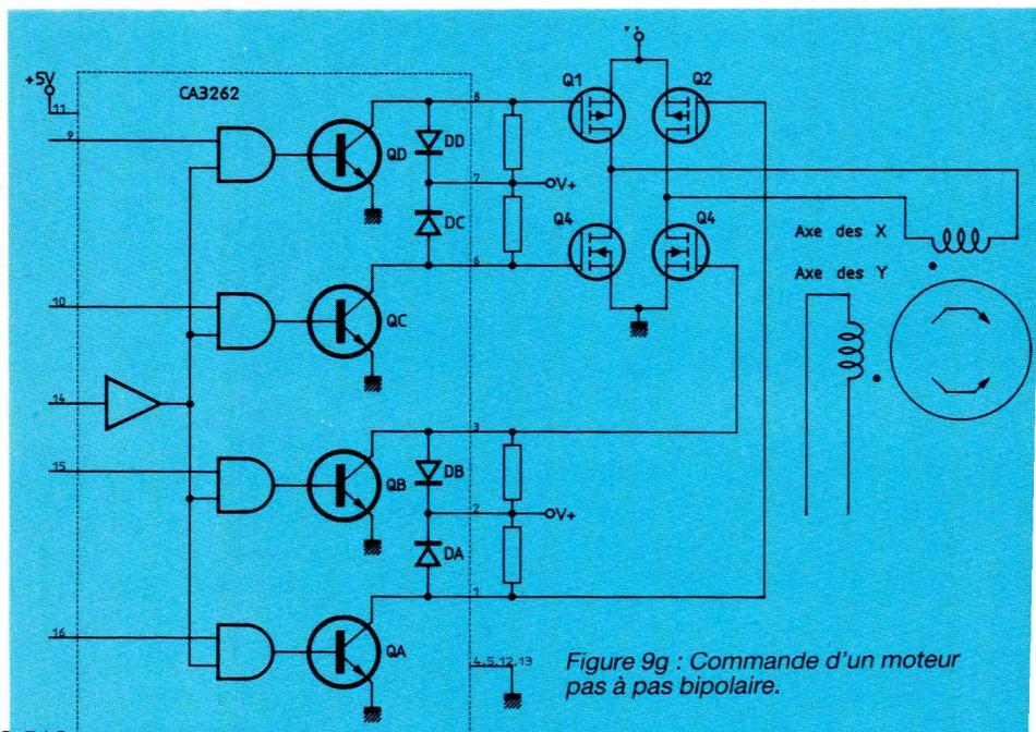
Figure 9g : Commande d'un moteur pas à pas bipolaire.
