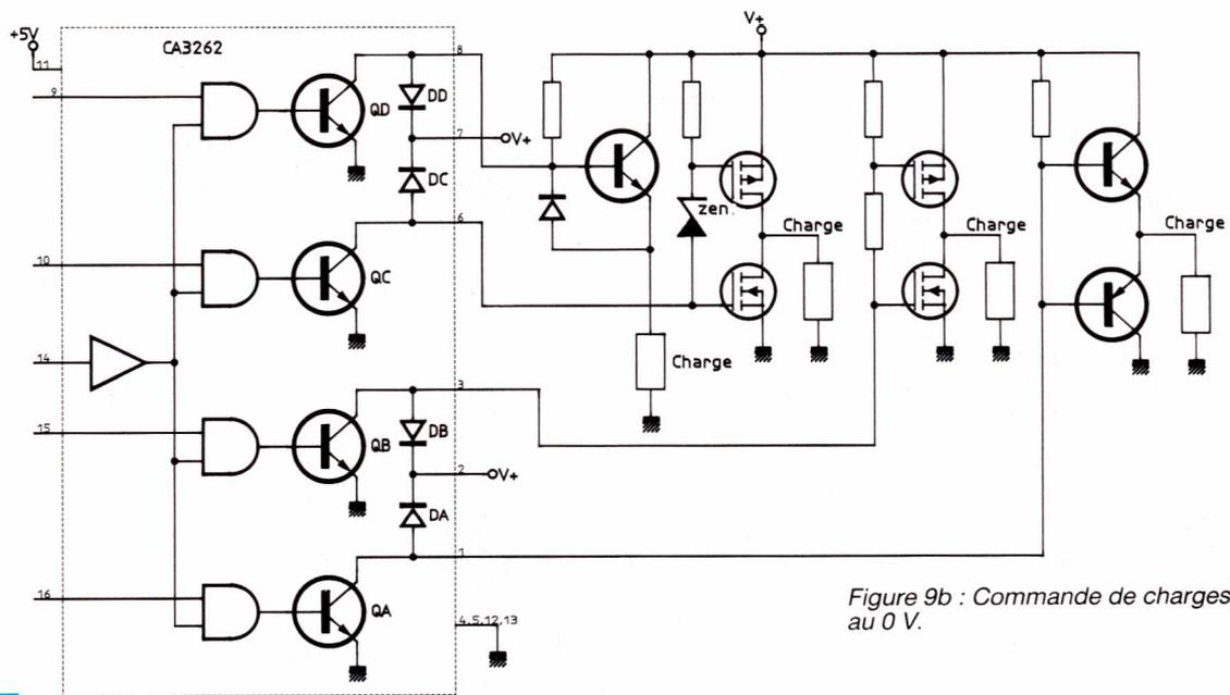
Figure 9b : Commande de charges au 0 V.
