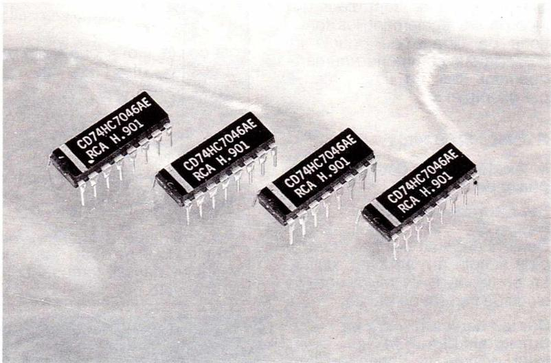
Contrairement à ce que l'on pourrait croire, ces PLL's sont tout aussi capables de traiter des signaux numériques qu'analogiques. Tout dépend du type de comparateur de phase utilisé. Nous allons concrétiser ces propos en décrivant le détecteur de phase à échantillonnage, le filtre de boucle numérique et l'oscillateur contrôlé numériquement de telles PLL.
