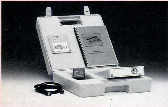
L'ensemble COMM'net est livré en mallette avec bloc alim. secteur, un cordon MINITEL, le BASIC intégré, un manuel d'utilisation extrêmement complet (180 pages) en français et un logiciel de communication (3,5") + exemples de programmes.
