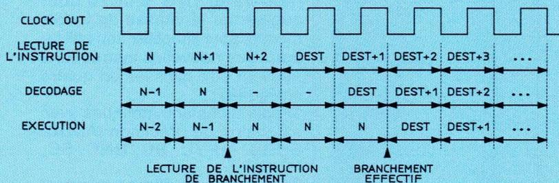
la lecture et le décodage peuvent être fait en un seul cycle. A ce moment, le pipeline est réduit à deux niveaux. Ceci n'augmente pas pour autant la vitesse d'exécution du fait que l'horloge ne change pas et qu'une seule instruction sera exécutée par cycle d'horloge.
