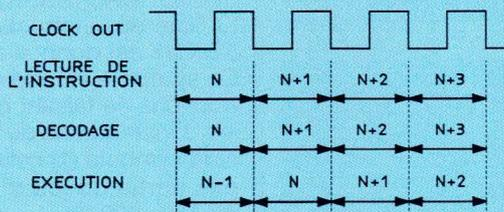
Concrètement, lorsque le DSP est en train d'exécuter une instruction il lit au même instant une autre instruction se trouvant deux pas de programme plus loin. En conséquence, lorsqu'une instruction de branchement est rencontrée, ce joli mécanisme est fortement perturbé et il faut alors plusieurs cycles au DSP pour reprendre son rythme. Cette dernière remarque est primordiale lorsque vous avez à écrire un programme devant s'exécuter en temps réel.
