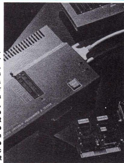
Système complet réalisé sur C.I. en 6 couches pour la programmation et le test des Eeproms, Eeproms, Bpoms, MPUs, PLDs et TTLs (74 et 75), SRAM & DRAM. Ce système, adopté par de nombreux utilisateurs (Dassault, Aérospatiale, SNCF, Telecom), fonctionne par une carte PC 8 bits permettant l'échange de données à grande vitesse avec le boîtier via un câble de 25 broches. Le programmeur est fourni avec un logiciel MS DOS complet comprenant de nombreuses fonctions:
