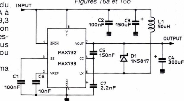
Dans le cas, par exemple, d'un programmeur de mémoires «flash» alimenté en +5 V seulement, on pourra se servir de cette broche pour commander l'application de la tension de programmation de +12 V.
