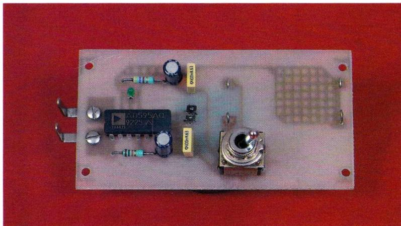
réglages (comme les résistances déterminant le gain de l'amplificateur) sont accessibles sur certaines broches du boîtier. Ainsi, il est possible de recalibrer le circuit intégré afin de l'utiliser avec certains thermocouples de types différents.
