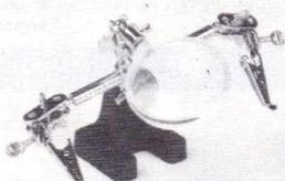
Appareil de maintien universel pour CI, câbles, composants...
