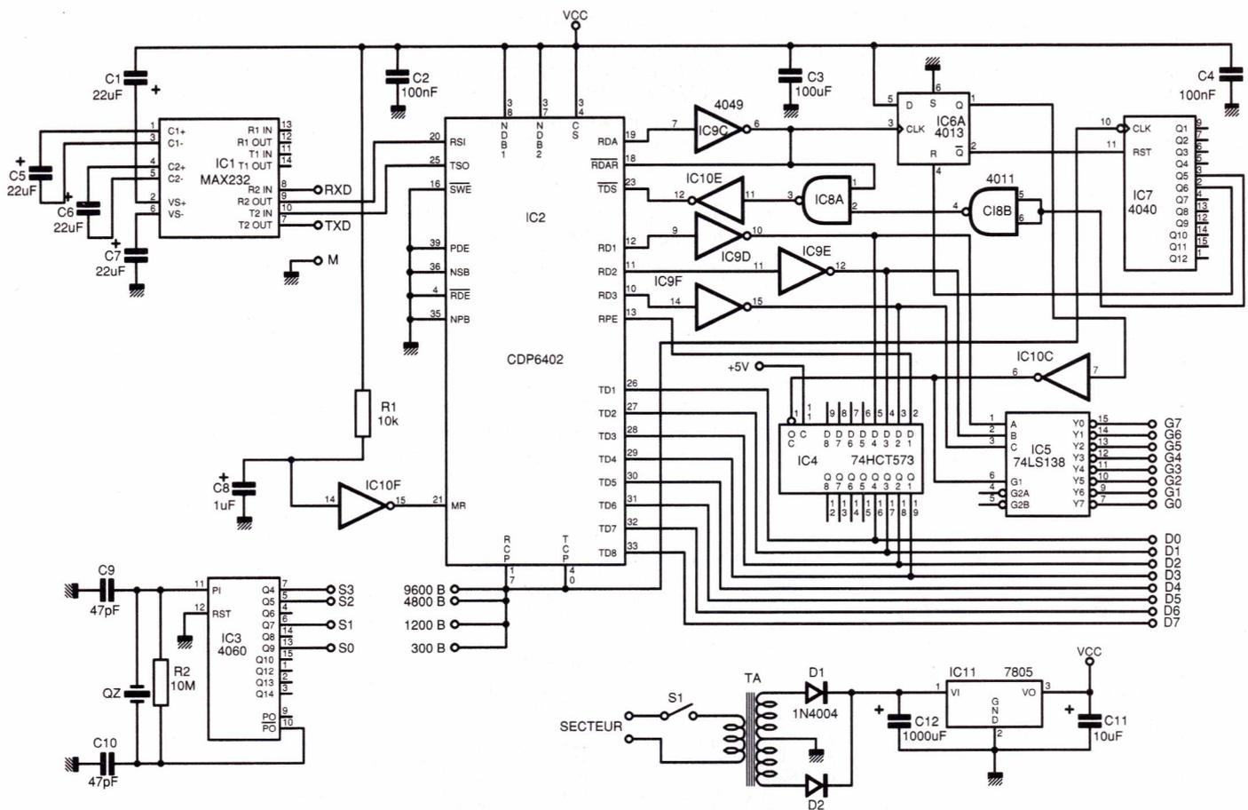
Fig. 5 : Schéma complet de la carte de base.
