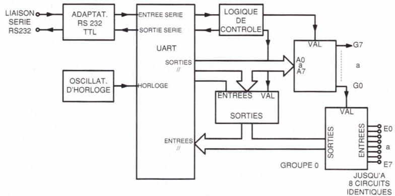
Fig. 4 : Synoptique de notre montage.
