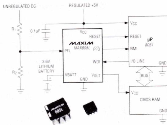
Les MAX805L et 813L avec un reset actif au niveau haut sont adaptés aux microcontrôleurs Intel de la famille 80C51 et à ses nombreuses secondes sources (Philips, Siemens, Matra Harris, ...).
