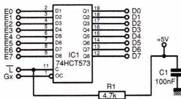
Fig. 6 : Schéma d'un module d'entrée.
