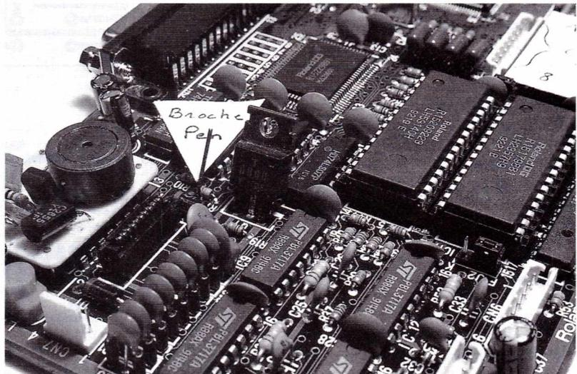
Les tables Roland DXY, distribuées par les établissements AN-GALIS, sont parfaitement utilisables pour travailler avec un système de phototraçage, mais encore faut-il «sortir» les signaux nécessaires tels que moteur X, moteur Y et PEN, après les avoir inversés.
