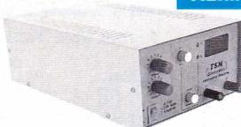
Caractéristiques : Alimentation 220 V 50/60 Hz - Tension de sortie max : 1,5 v à 15 v - Courant de sortie max : 2 A - Affichage numérique 3 digits - Réglage en tension et courant - Variation secteur ± 10 % - Ondulation résiduelle elf 20 mv.
