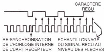
Fig. 3 : Principe de la synchronisation et de l'échantillonnage des données.
