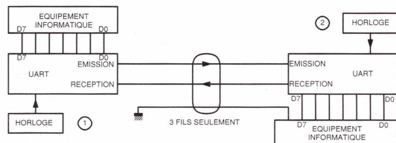
Fig. 2 : Synoptique d'une liaison série asynchrone type.
