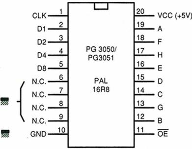
Figure 11 : raccordement décodeur/afficheur.
