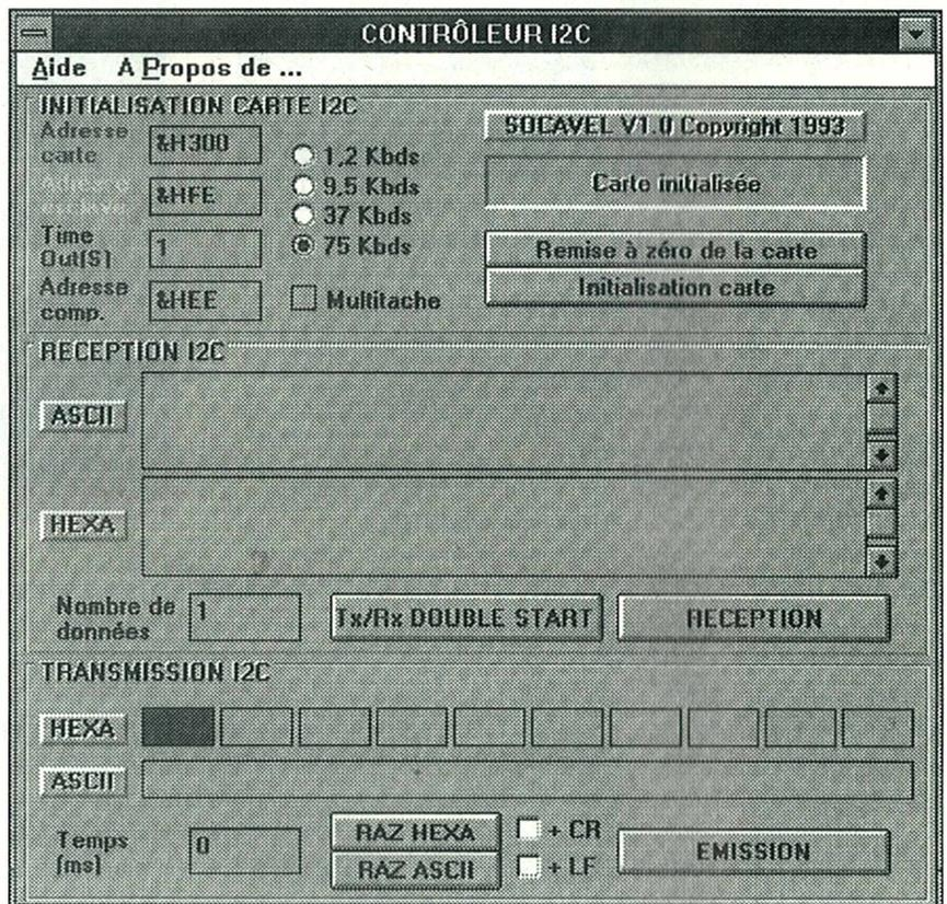
Figure 2 : recopie d'écran du logiciel en mode évaluation du bus I2C.
