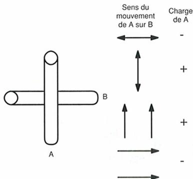
Figure 1 : la surface de frottement de deux isolants identiques influe sur le signe de la charge finale portée par le bâton A et donc sur celui, opposé, de la charge portée par B (d'après Grüner).
