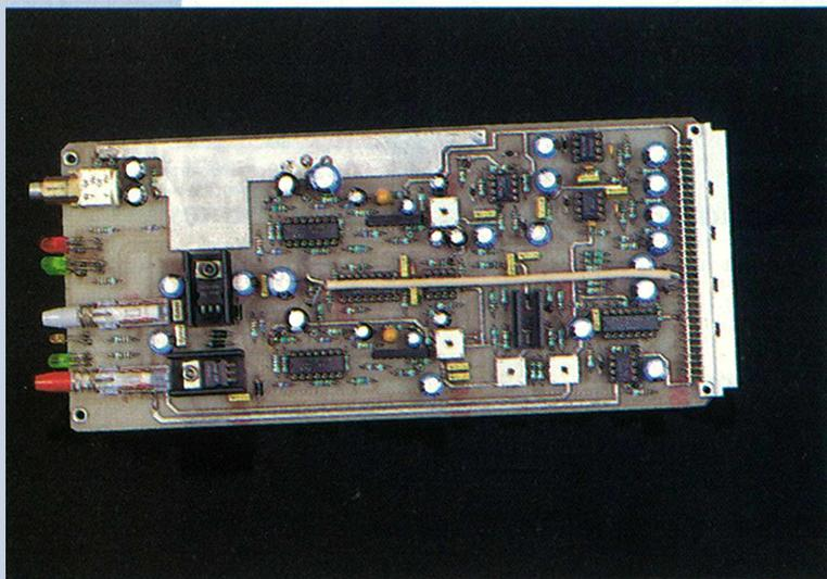
La réalisation que nous proposons ici a été conçue pour précéder des cartes filtres dynamiques, telles celle décrite dans le n° 548. On pourra néanmoins l'exploiter à d'autres fins, comme, par exemple, pour les versions de Hilpac en deux fois 120 W, stéréo + 60 W, mono, ou encore l'insérer
