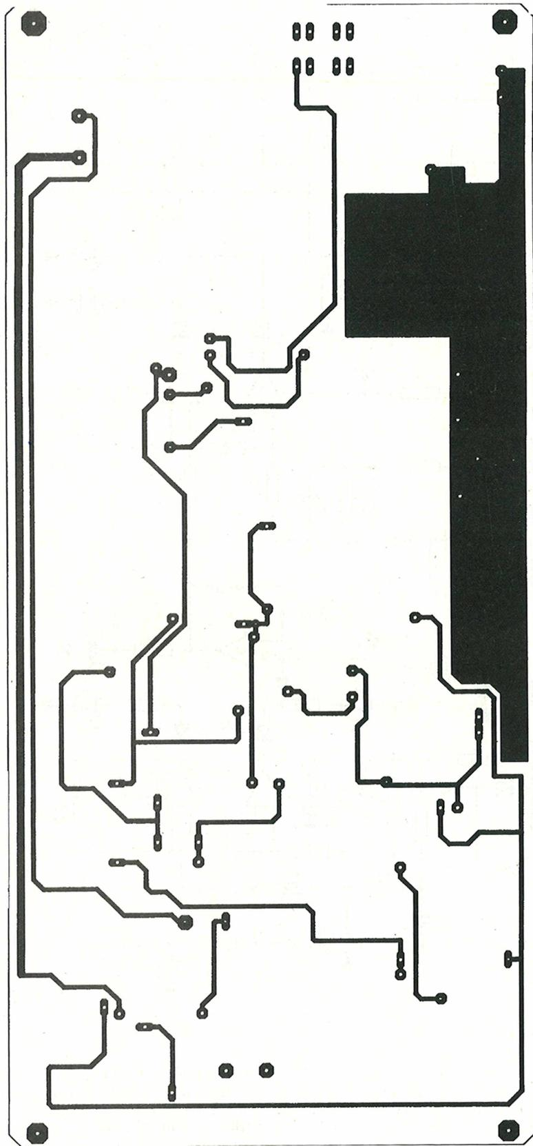
■ Figure 4a : circuit imprimé côté composants.
