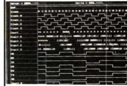
Ces Analyseurs Logiques se présentent sous forme de cartes courtes pour PC sont livrés avec 16 sondes et le programme sur PC. A l'écran du PC des "fenêtres" permettent de configurer le nombre de voies, la vitesse d'horloge externe et interne, le nom des fichiers à sauvegarder ainsi que les paramètres "type".
