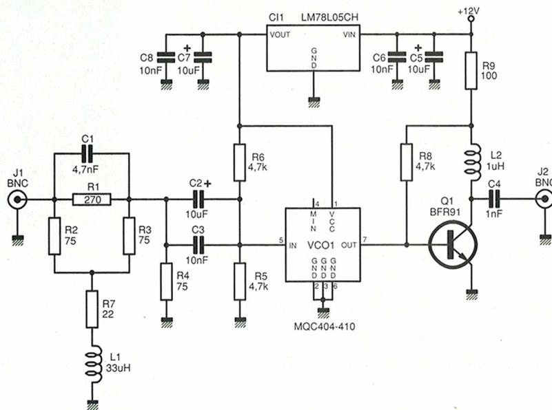
Figure 1 : schéma de notre émetteur.
