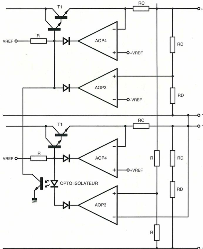
■ Figure 3b : la régulation en mode tracking.
