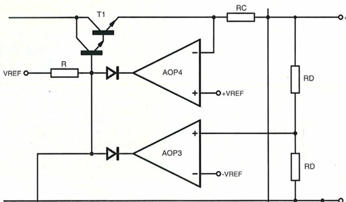
■ Figure 3a : principe de la régulation.
