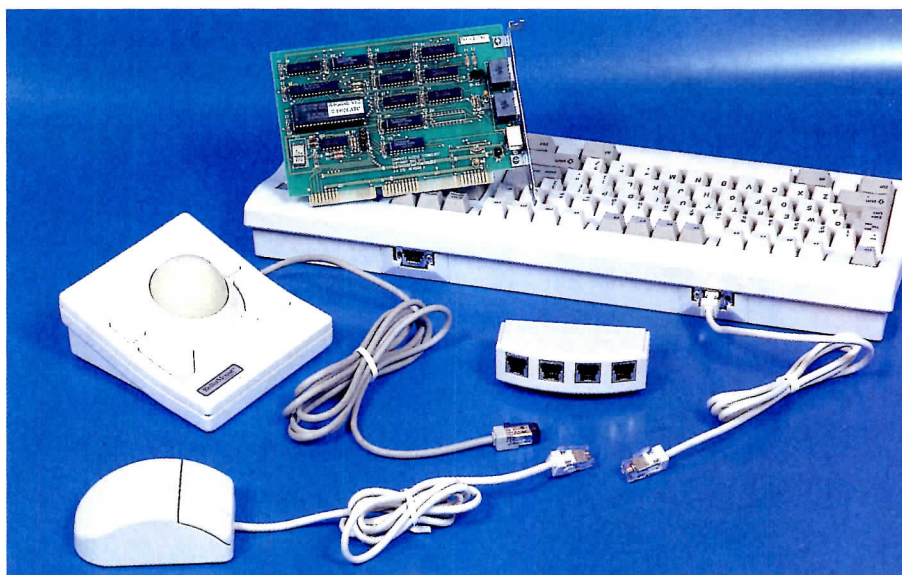
■ Figure 1 : l'ACCESS BUS permet de chaîner tous ces périphériques avec un seul point d'accès à la carte s'enfichant dans l'ordinateur.
