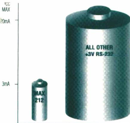
Le courant de repos (5 mA en mode normal) chute à 1  $\mu$ A en mode veille, mode dans lequel les récepteurs restent actifs. Les récepteurs ont des sorties triac états permettant de réaliser des OU câblés au niveau d'une UART. Le MAX212 est conforme aux normes EIA/TIA-232E, EIA/TIA-562 et V28/V24. Pour une alimentation Vcc aussi basse que 3 V, le MAX212 garantit un slew-rate de 4 V/ $\mu$ s min., une vitesse de 120 Kbps min. et une dynamique de sortie de  $\pm 5$  V min.
