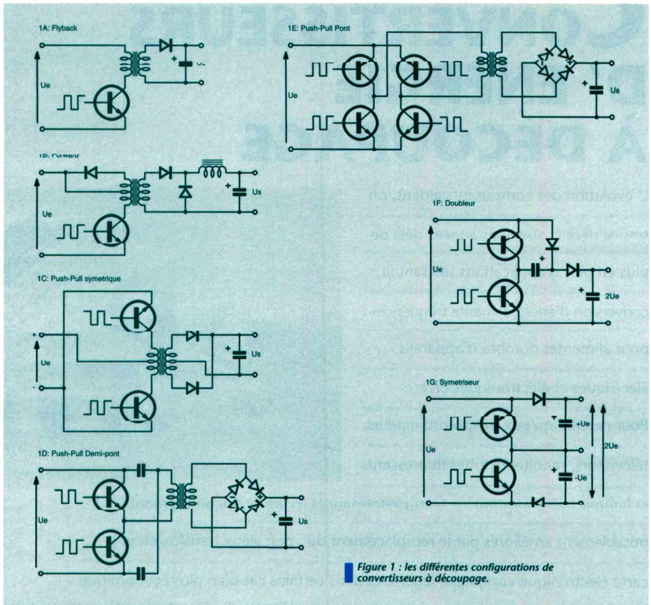
Figure 1 : les différentes configurations de convertisseurs à découpage.
