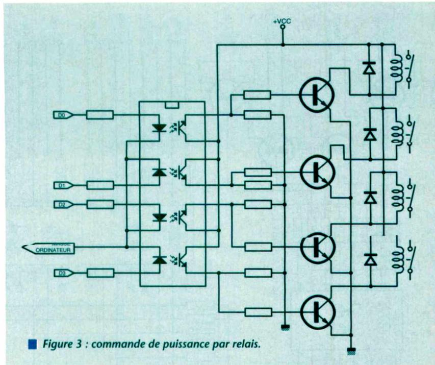
■ Figure 3 : commande de puissance par relais.
