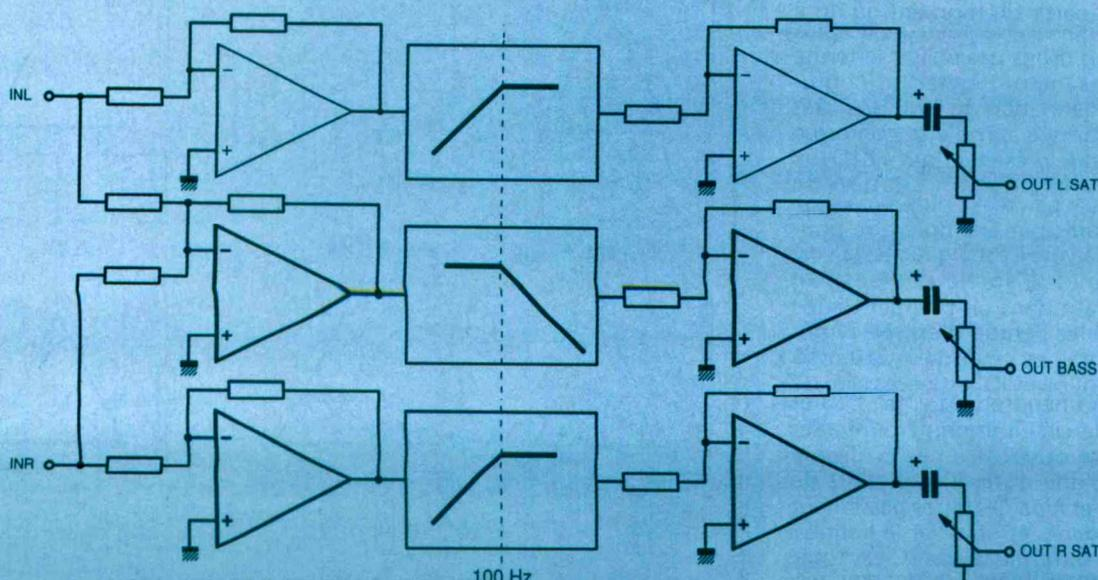
■ Figure 5 : synoptique d'un filtrage actif deux voies.
