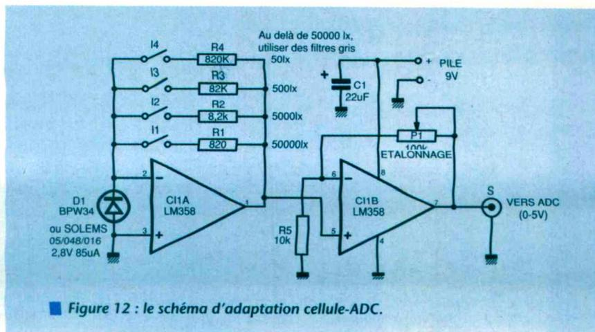
Figure 12 : le schéma d'adaptation cellule-ADC.
