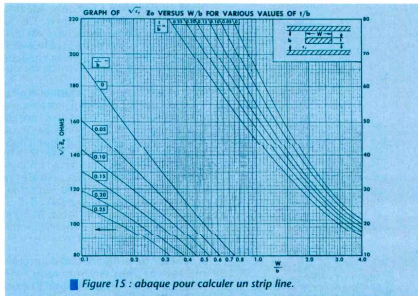
Figure 15 : abaque pour calculer un strip line.
