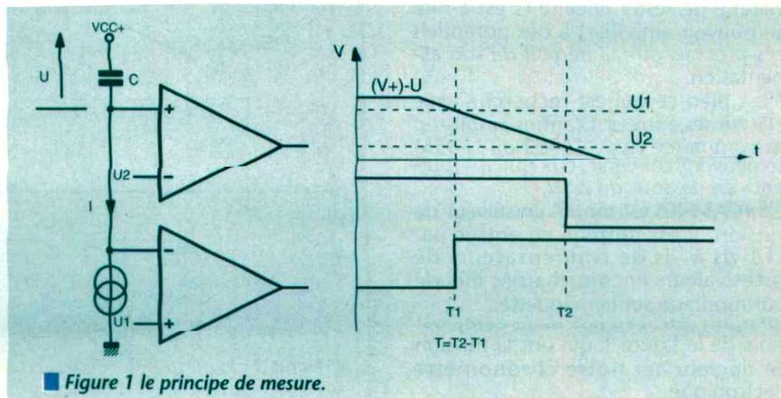
■ Figure 1 le principe de mesure.
