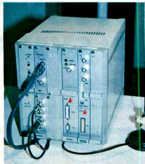
■ Philips : Système de tests PDS, générateur de signaux DAB.
