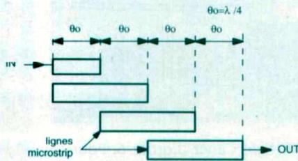
Figure 14 : Couplage entre lignes mis à profit pour la réalisation d'un passe-bande étroit.
