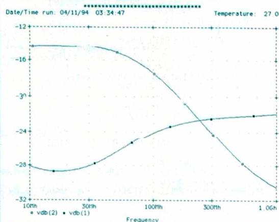
■ Même étage simulé avec une inductance parasite 40 nH
