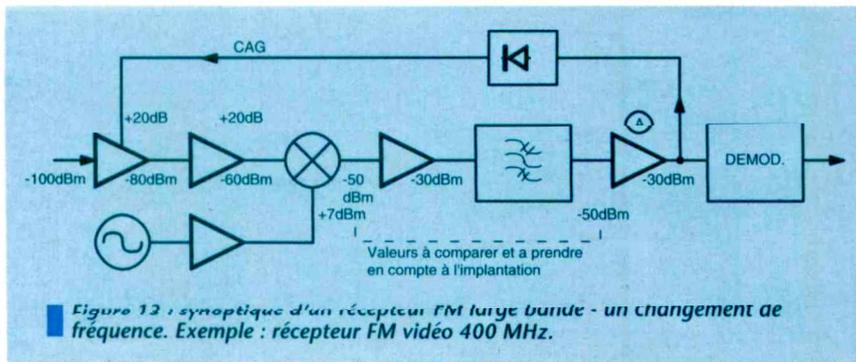
Figure 12 : synoptique d'un récepteur FM large bande - un changement de fréquence. Exemple : récepteur FM vidéo 400 MHz.
