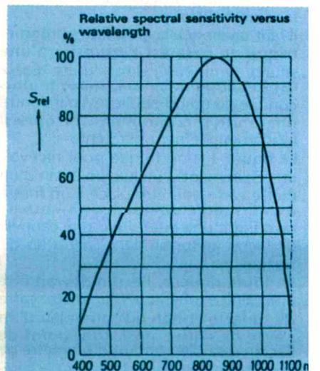
■ Figure 5 : réponse spectrale de la BPW 34
