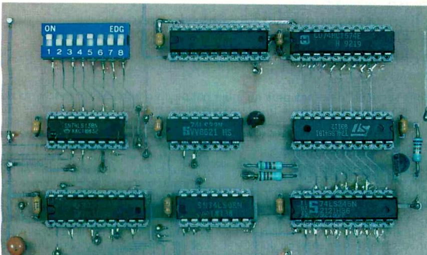
également, au niveau bas, le circuit C12, un tampon huit bits bi-directionnel, utilisé pour isoler le bus de données du PC de la carte interface lorsque celle-ci n'est pas en fonction. La direction du transit des données est déterminée par le niveau appliqué sur la broche DIR. Lorsque ce dernier est bas, la carte peut transmettre des données vers le bus du microprocesseur. Lorsqu'il présente un niveau haut, le sens de transfert est inversé.
