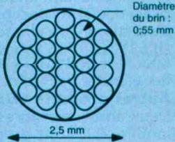
**Figure 6 : circonférence utile pour un conducteur de 2,5mm de diamètre : 7,85mm**
