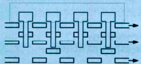
Figure 17 : implantation du commutateur avec Stripline.
