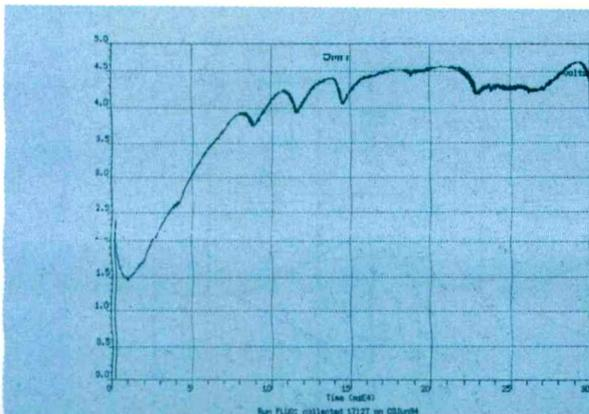
■ Figure 15 : établissement de l'éclairement au bout de 5 mn de fonctionnement d'une ampoule basse consommation 20 W.
