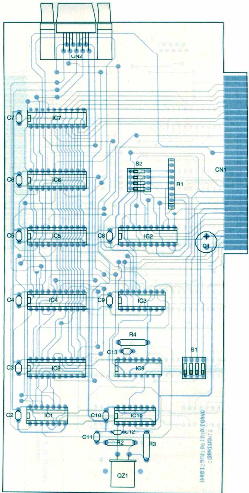
■ Figure 5 : l'implantation de Quad I2C, ne pas oublier les traversées.
